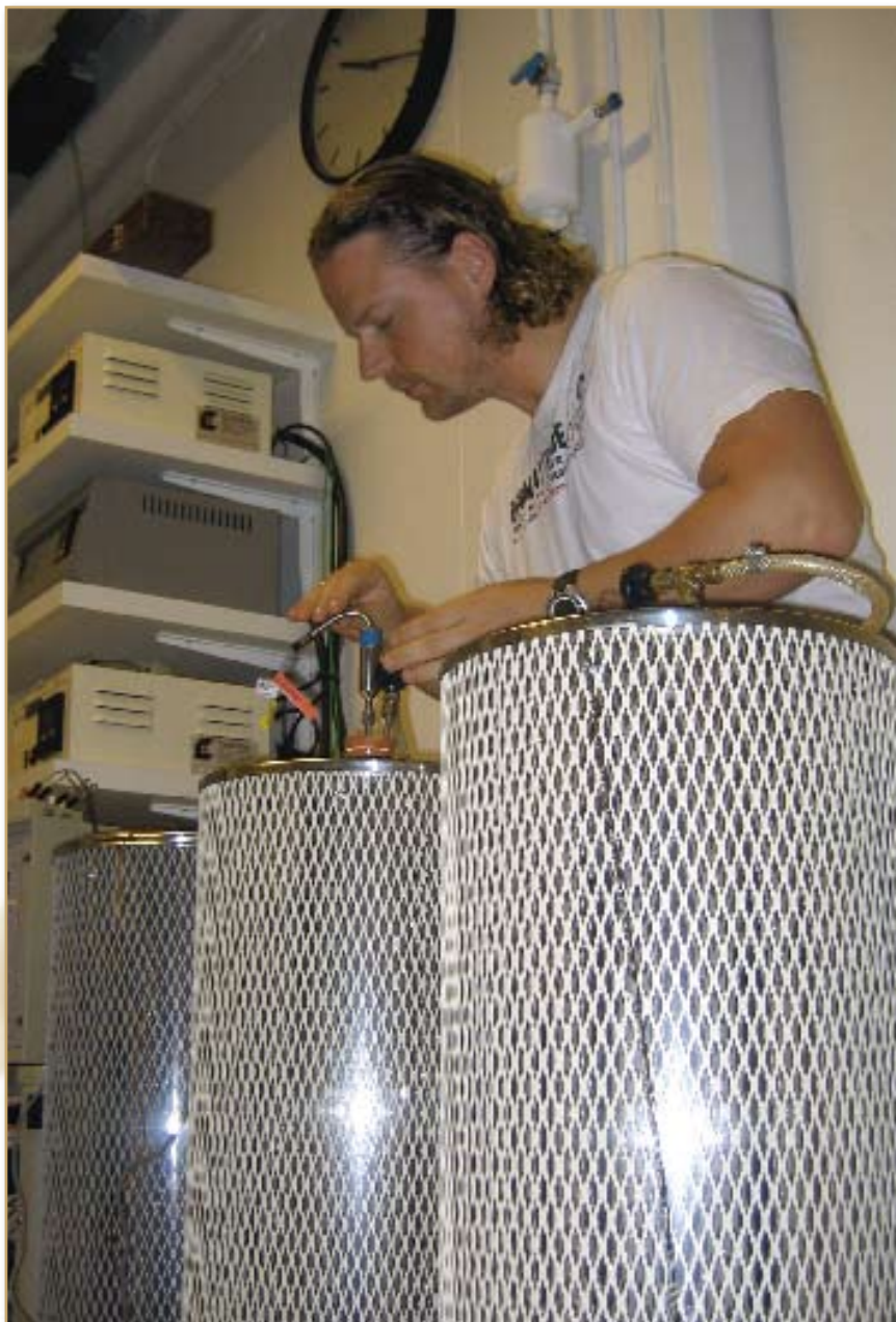
Kalibrering af Standard Platinum Resistans Termometre (SPRT) med en usikkerhed på 1-8 mK kræver omhyggelighed, tålmodighed planlægning. Her ses en række tøndelignende ovne på Teknologisk Institut indeholdende fikspunkterne for indium (In), tin (Sn) og zink (Zn) i forgrunden, samt målebrog og forfatteren i baggrunden med et SPRT.
