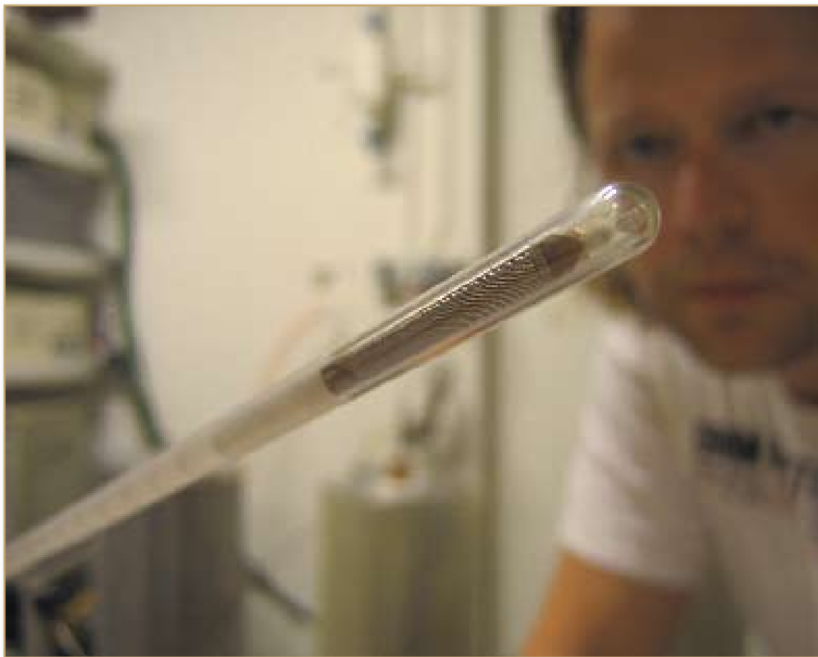
Ultrapræcist »state of the art« termometer, der kalibreres i fikspunktslaboratoriet. Den officielle betegnelse er Standard Platinum Resistans Termometre (SPRT).
