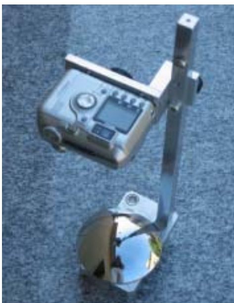
HORIZCATCHER til analyse af skyggegivere i horisonten.
