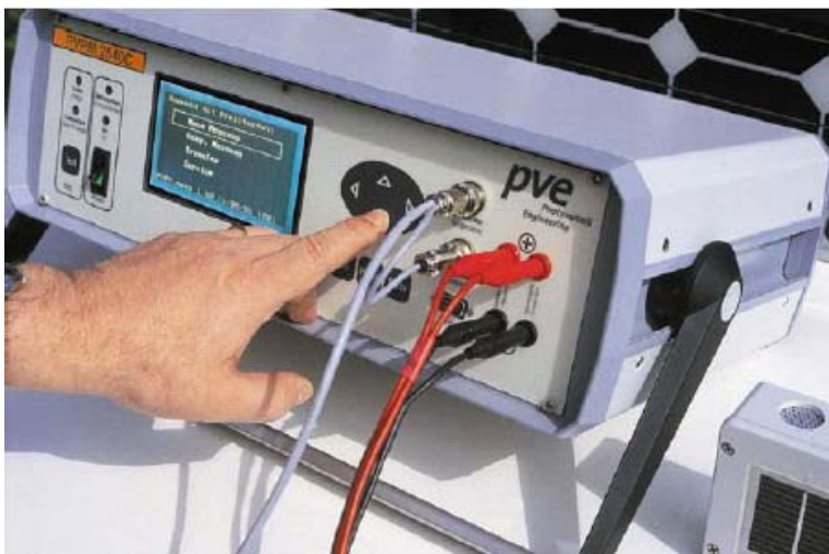
PVPM6020C til måling af strøm-spændingskurve og bestemmelse af nominel effekt.
