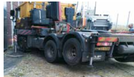
Ups! Kranvognen tippede lidt, lige før thermoformeren var placeret langt nok inde på ladvognen (som ses foran kranen).
