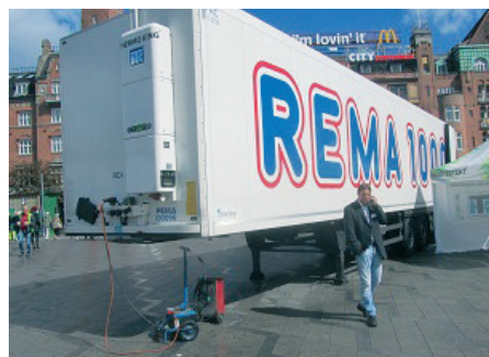
Rema 1000 – hænger med støjsvagt køleudstyr.
