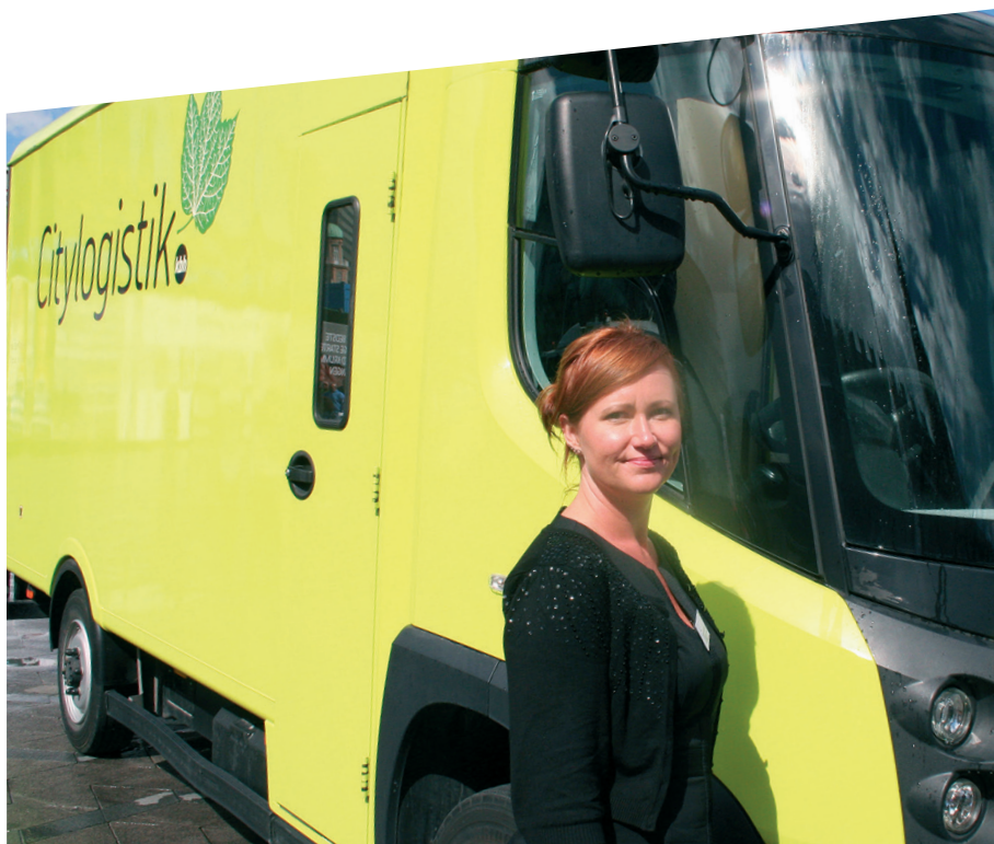
Projektchef Christina Bech Godskesen Andersen fra Copenhagen Business School foran nyeste skud på stammen hos Citylogistik-kbh, en elreven Modec lastbil med rattet i højre side. Den kan rumme seks paller og rækker ca. 160 km på en opladning. Totalvægten er 5,5 ton. Foto: John Larsen.
