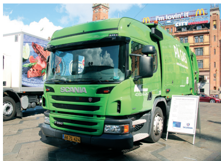
M. Larsen Vognmandsfirma viser en ny gasdrevne Scania med Norba komprimatoranlæg. Foto: Finn Bjerremand.
