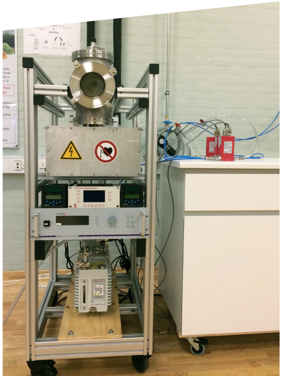
Figur 1. Et såkaldt plasma enhanced chemical vapor deposition (PECVD) anlæg.
