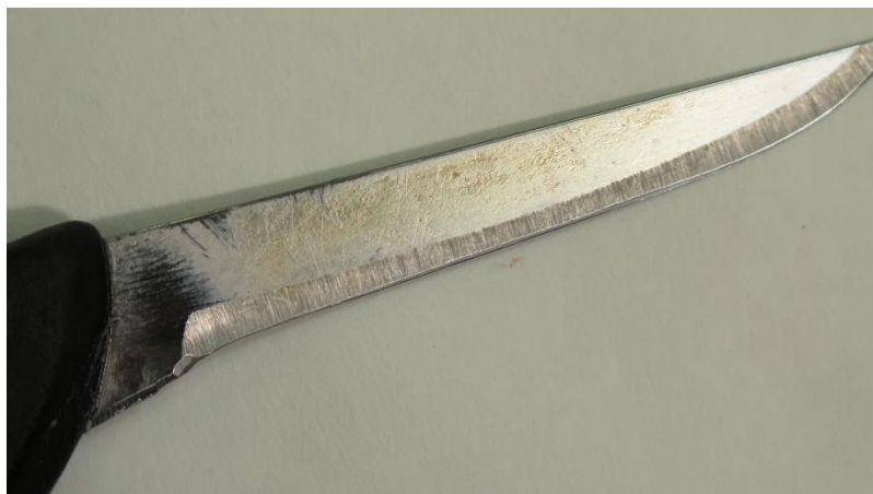
Billede 4 – kniv med høj belægningsgrad efter desinfektion ved neddykning i 82°C varmt vand. Driftstid 30 minutter.
