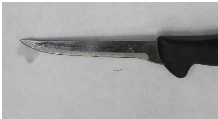
Billede 8 – kniv med lav belægningsgrad efter desinfektion med Inspexx 210. Behandlingen omfattede 1 sekunds forskyl med lunt vand 42°C, 1 sekunds desinfektion med Inspexx 210 (300 ppm pereddikesyre) og 0,5 sekunders efterskyl med 42°C lunt vand. Driftstid 60 minutter.
