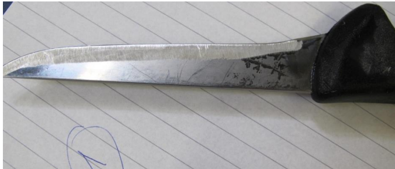
Billede 6 - Kniv med moderat belægningsgrad efter desinfektion med Neuthox. Behandling omfattede et forskyl med 42°C lunt vand på 0,5 sek.; desinfektion med 35 ppm frit klor, pH 8,1 i 0,5 sek. og et efterskyl med 42°C lunt vand på 0,5 sek. Driftstid 85 minutter.
