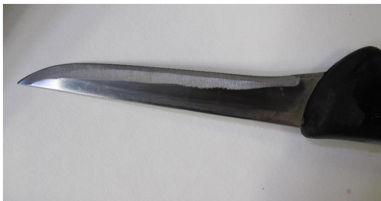
Billede 3 - kniv med lav belægningsgrad efter desinfektion med 82°C varmt vand i 0,5 sek. (dvs. ingen for- eller efter-skyl). Driftstid 4½ time.
