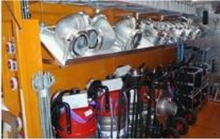
Pumper med en ydelse på 6200 l/min og 2400 l/min
