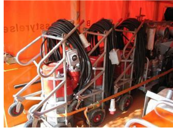
Pumper med en ydelse på 6200 l/min og 2400 l/min
