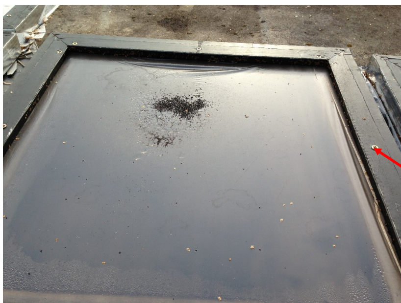
FIGUR 5.14 FOLIER PÅ TAG DEN 10. SEPTEMBER – FLÆNGER I SORT B LANG KANT.
