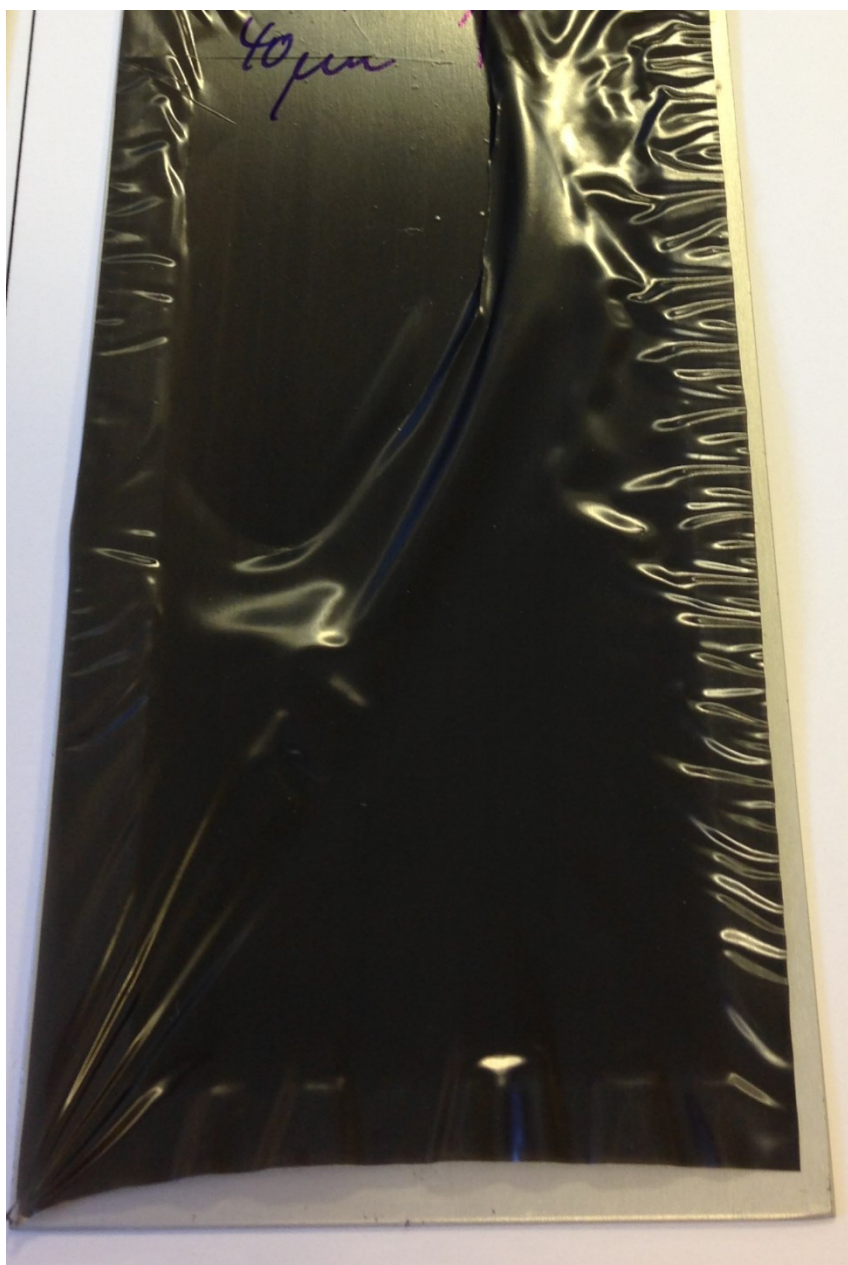
FIGUR 4.8: C (40 \mu\text{m} ) FOLIE EFTER TEST I WEATHER OMETER.
