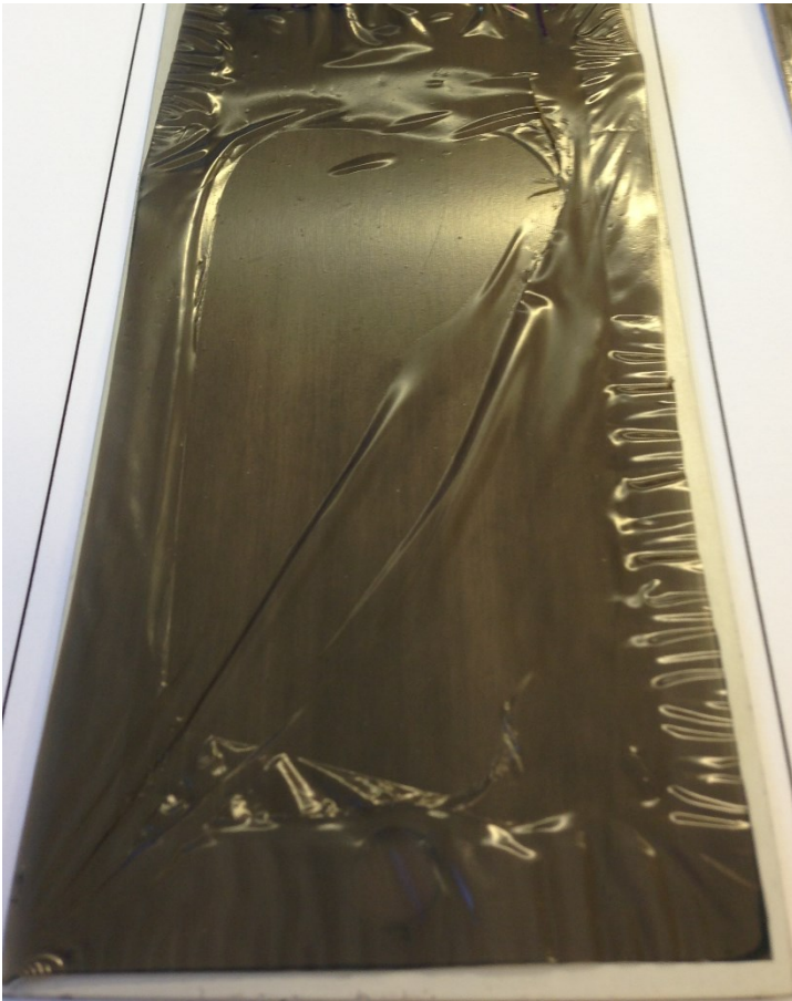
FIGUR 4.7: C (20 µM) FOLIE EFTER TEST I WEATHER OMETER.
