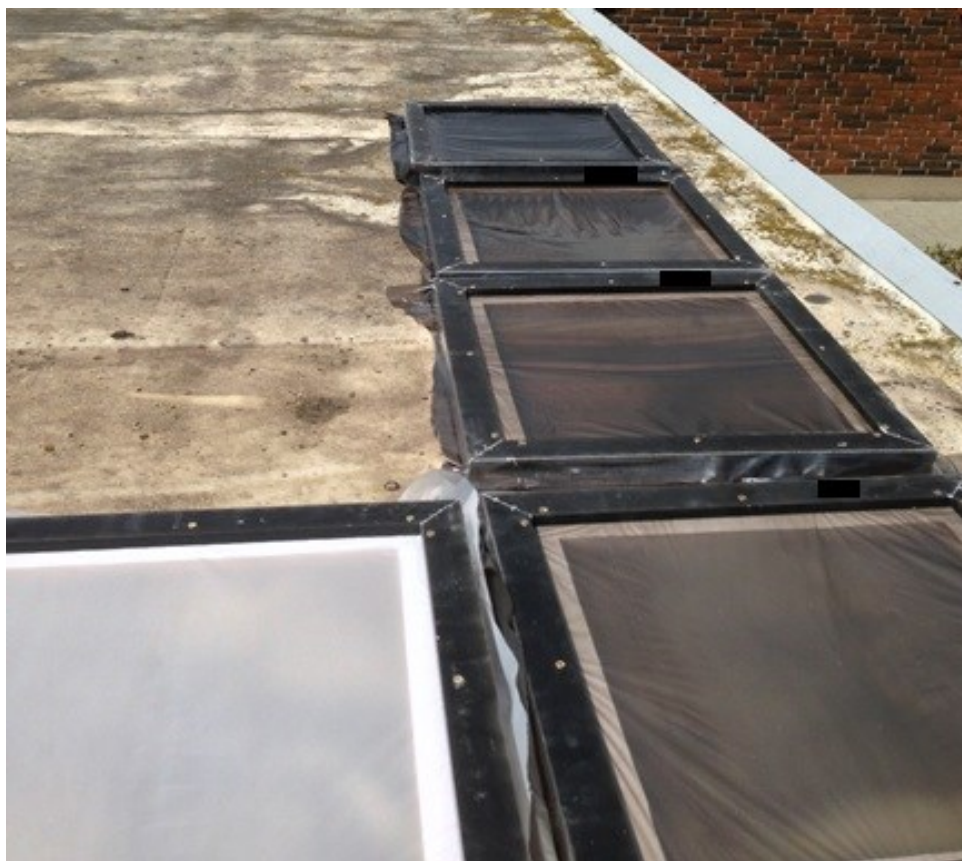
FIGUR 5.6 FOLIE I RAMMER UDLAGT PÅ TAG – INGEN JORDEKSPONERING – START 19/7-2013
