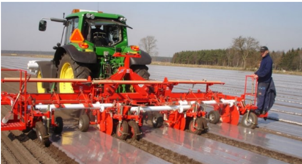
FIGUR 5.36: 3 RÆKKET UDLÆGGER MED VERTIKAL NEDFÆLDELSE AF FOLIESIDER.
