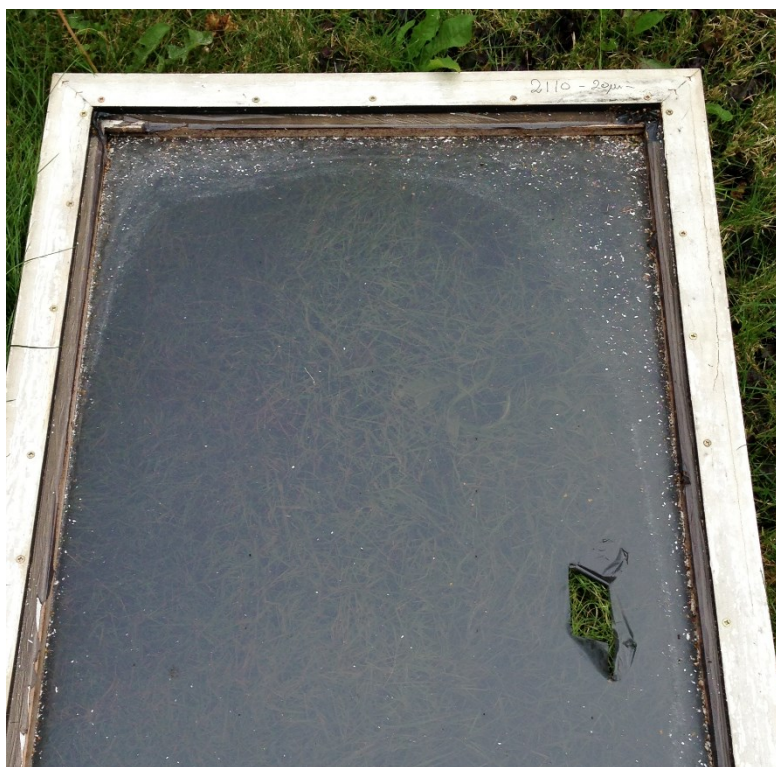
FIGUR 5.13. FOLIER PÅ GRÆS DEN 8. SEPTEMBER – STORE FLÆNGER I SORT B
