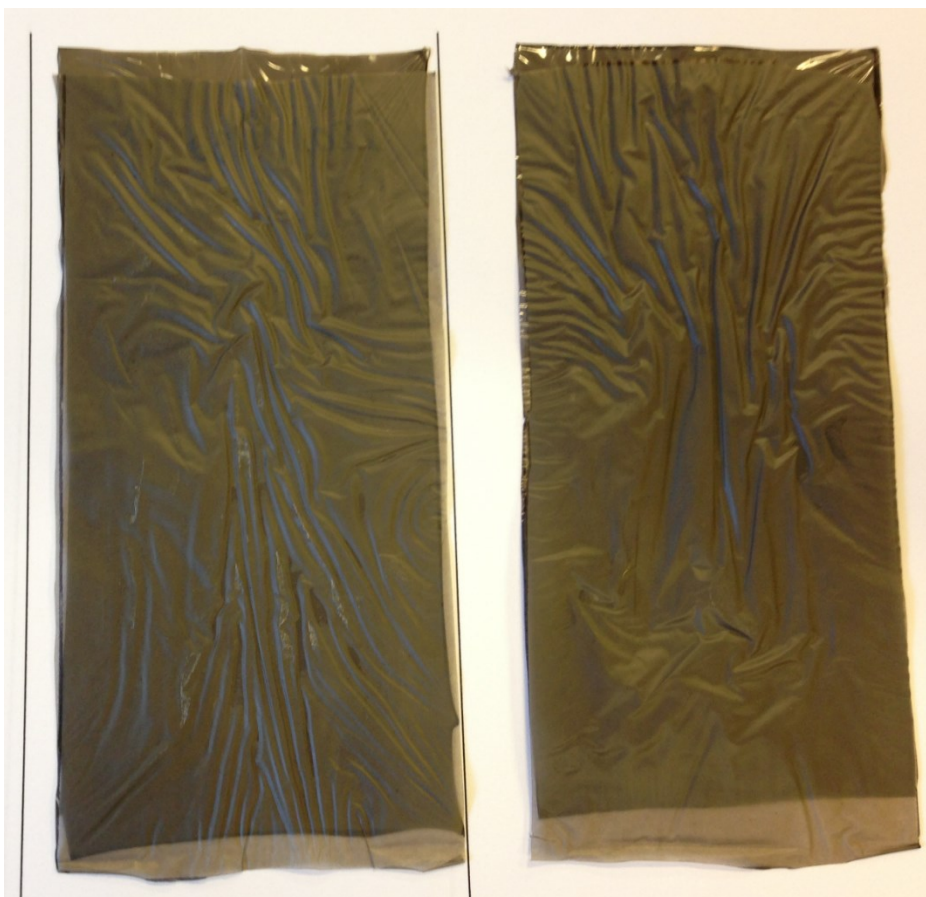
FIGUR 4.11: A (20 \mu\text{M} ) OG C (20 \mu\text{M} ) FOLIE EFTER TEST I WEATHER OMETER. (BAGSIDEN – SIDEN DER VENDER VÆK FRA UV-LYSKILDEN)
