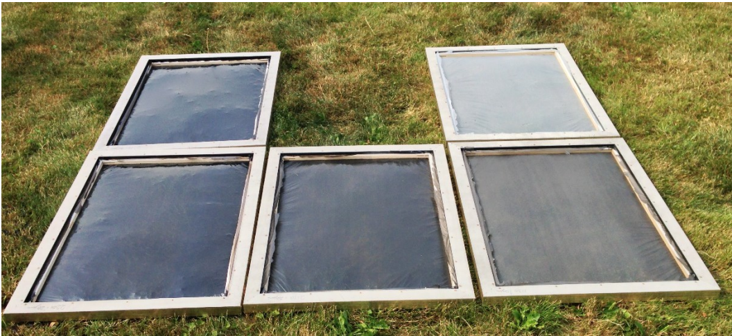
FIGUR 5.7 FOLIE I RAMMER UDLAGT PÅ GRÆSPLENE – START 26/7-2013
