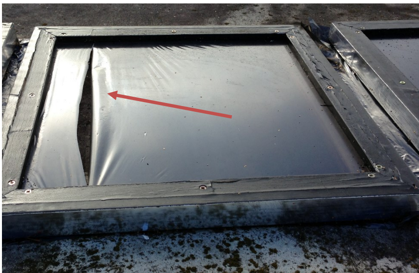
FIGUR 5.15 FOLIER PÅ TAG DEN 21. SEPTEMBER – FLÆNGER I SORT C 20 \mu M (RIVESTYRKE)
