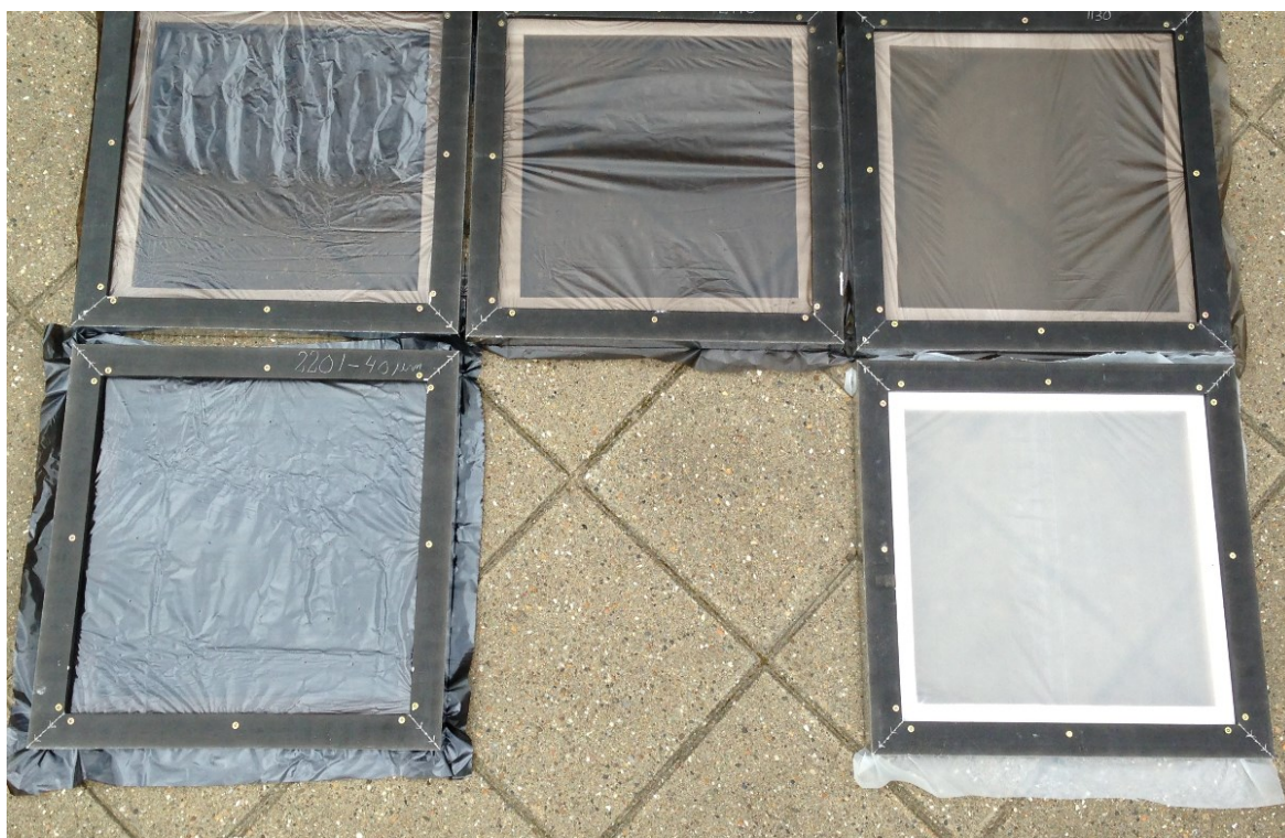
FIGUR 5.5 FOLIE I RAMMER TIL UDLÆGNING PÅ TAG – INGEN JORDEKSPONERING – START 19/7-2013.
