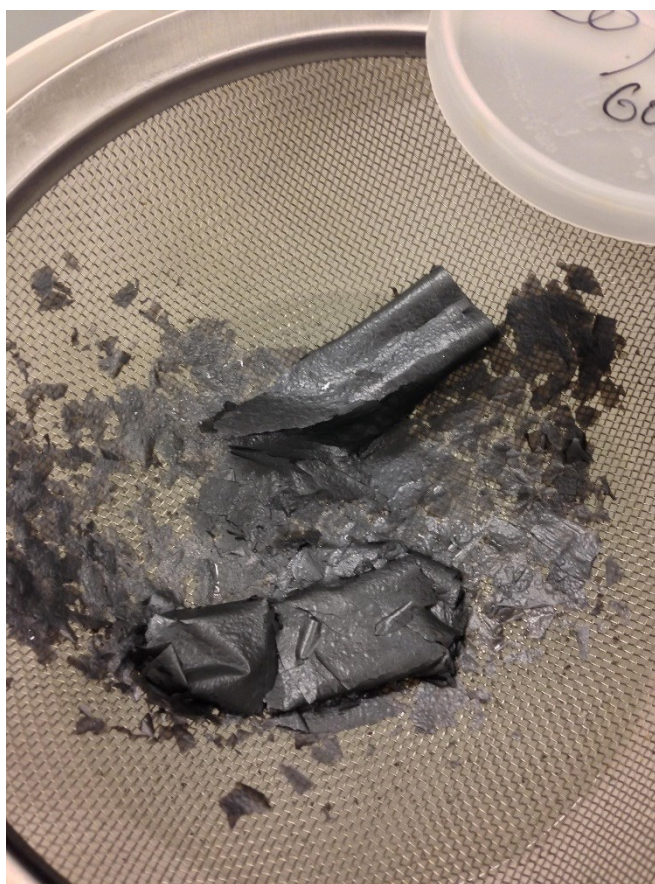
FIGUR 4.3: C RESTER EFTER AFSLUTNING AF FORSØG VED 60°C. FOLIEN VAR ØDELAGT
