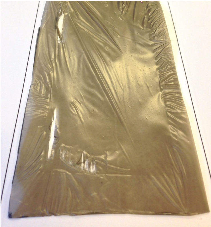
FIGUR 4.6: B FOLIE EFTER TEST I WEATHER OMETER.
