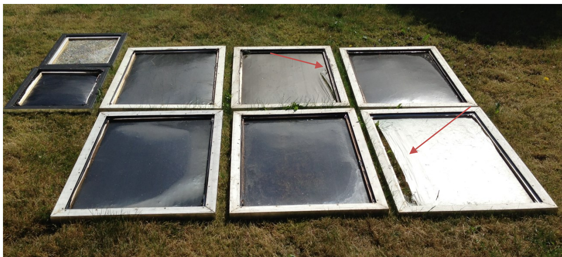
FIGUR 5.12. FOLIER PÅ GRÆS DEN 31. AUGUST – STORE FLÆNGER I SORT OG HVID A. ØVRIGE OK
