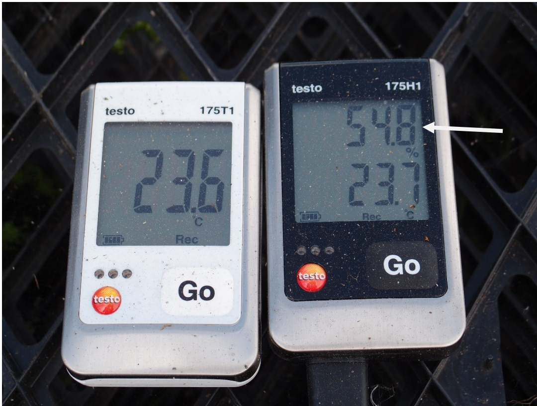
Figur 1. De 2 typer loggere, hvor den ene også kunne måle luftfugtighed (logger 2)
