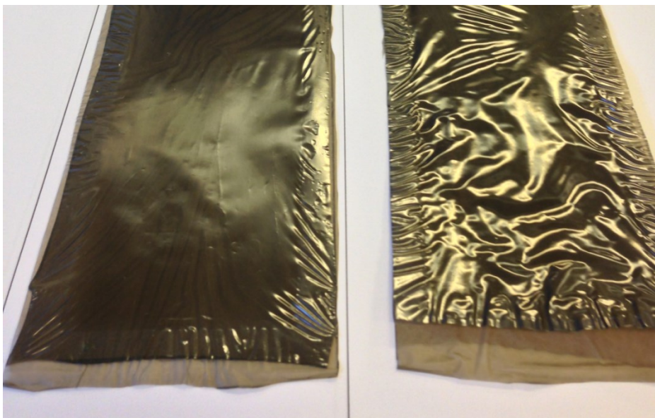
FIGUR 4.10: C (20 \mu\text{M} ) OG A (20 \mu\text{M} ) FOLIE EFTER TEST I WEATHER OMETER. (FORSIDEN – SIDEN DER VENDER UD MOD UV-LYSKILDEN)
