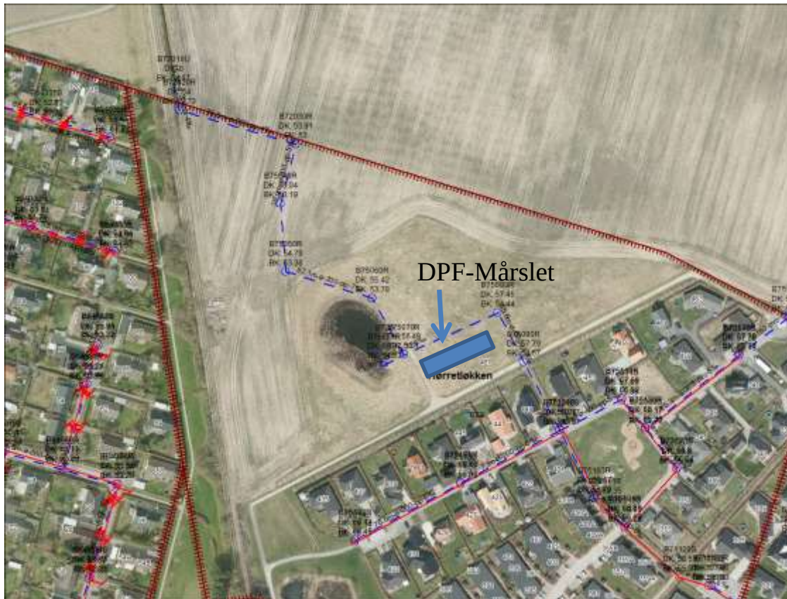
Figur 26. Omtrentlig placering af DPF-Mårslet nord for Hørretlykken i Mårslet (rektangel). Den eksisterende regnvandsledning er vist med stiptet blå linje. DPF-anlægget modtager vand via brønd tæt ved forsinkelsesbassinet til venstre i billedet.
