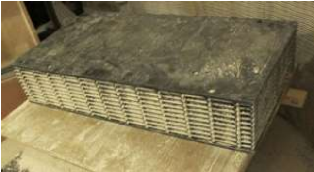
Figur 5: DPF-kassette indeholdende 9 dobbeltporøse lag. Vandets strømningsretning er fra gavl til gavl.
