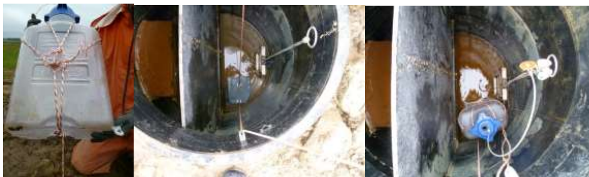
Figur 41. Passiv-prøvetager i udløb. Venstre: Til fastholdelse og optagning af prøvetageren er der bundet en snor i prøvetageren. Midt: På bunden af udløbsbrønden er en bundplade med snoretræk. Højre: Prøvetager monteret og snor til optagning fastgjort på siden af brønden. På billedet ses et skydespjæld, der under indkøringen af anlægget blev udskiftet med det forhøjede udløb for at sikre fuld og hurtigere fyldning af DPF-anlægget.
