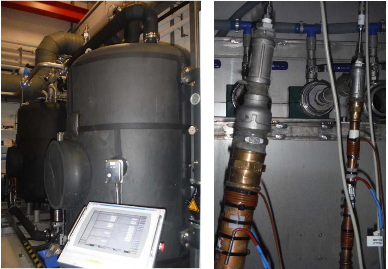
Figur 2: Tanke til termostatering af "koldt" og "varmt" (tv) og billede, der viser de to målerør med monterede temperatursensorer (th)
