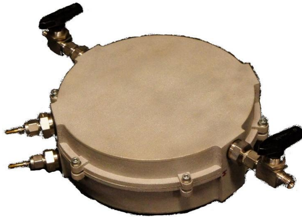
Figur 2: Prøvekammeret er lukket med seks skruer.
