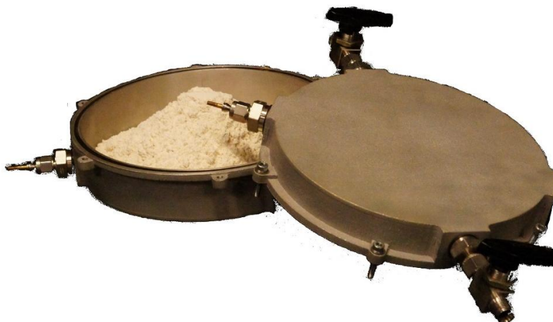
Figur 1: Prøvekommeret indeholdende pulver.
