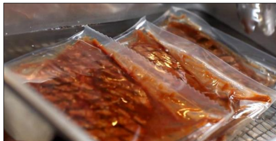
Eksempel på Mylar® Cook pakning inden varmebehandling
