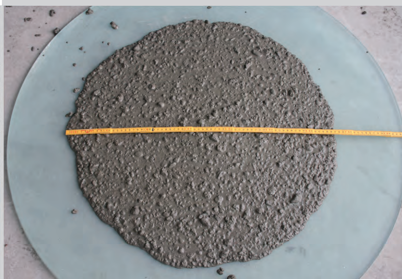
Figur 1.1. Sætmål for traditionel beton til venstre målt som sammensynkningen af en 300 mm høj betonkegle. Flydemål i form af diameteren for et tilsvarende SCC prøveemne ses til højre. Sætmålet for traditionel beton ligger typisk i intervallet 100-200 mm, mens flydemålet for SCC ligger på ca. 500-700 mm.
