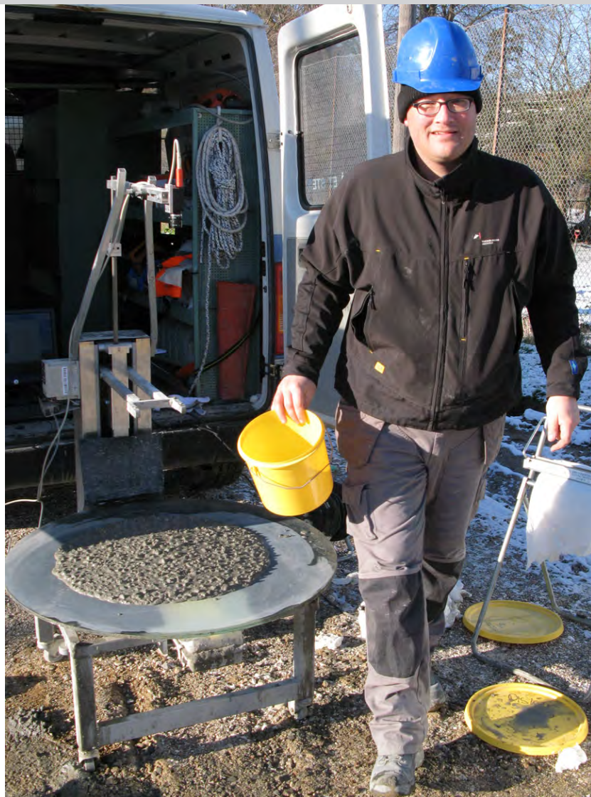
Figur 3.3. Automatiseret flydemålsforsøg anvendt som modtagekontrol. Til bestemmelse af flydemål og viskositeten (4C-Rheometer)
