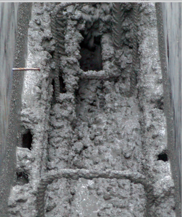
Figur 2.12. Blokering ved SCC støbning. Eksempler på tæt armering og ophobning af sten bag armering og stenreder.
