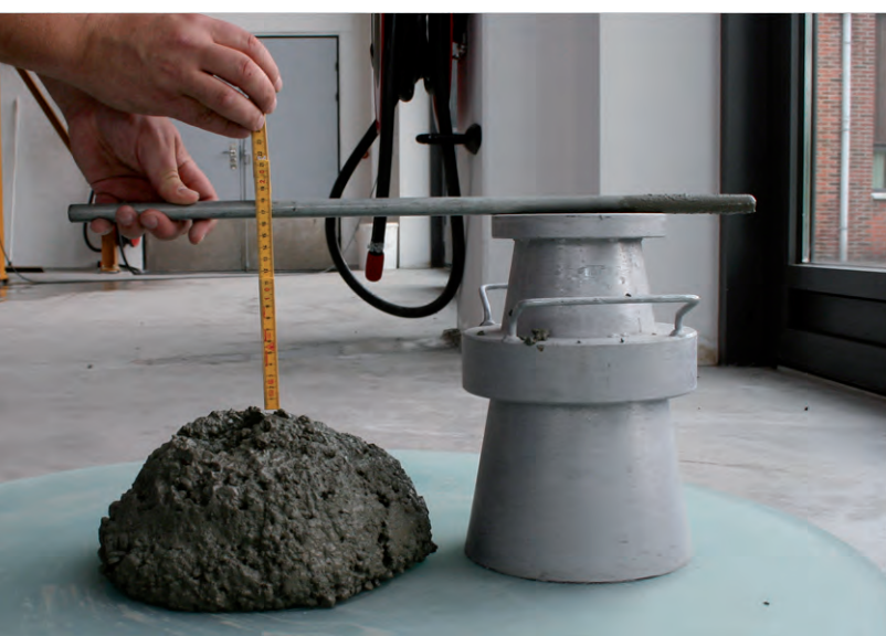
Figur 1.1. Sætmål for traditionel beton til venstre målt som sammensynkningen af en 300 mm høj betonkegle. Flydemål i form af diameteren for et tilsvarende SCC prøveemne ses til højre. Sætmålet for traditionel beton ligger typisk i intervallet 100-200 mm, mens flydemålet for SCC ligger på ca. 500-700 mm.
