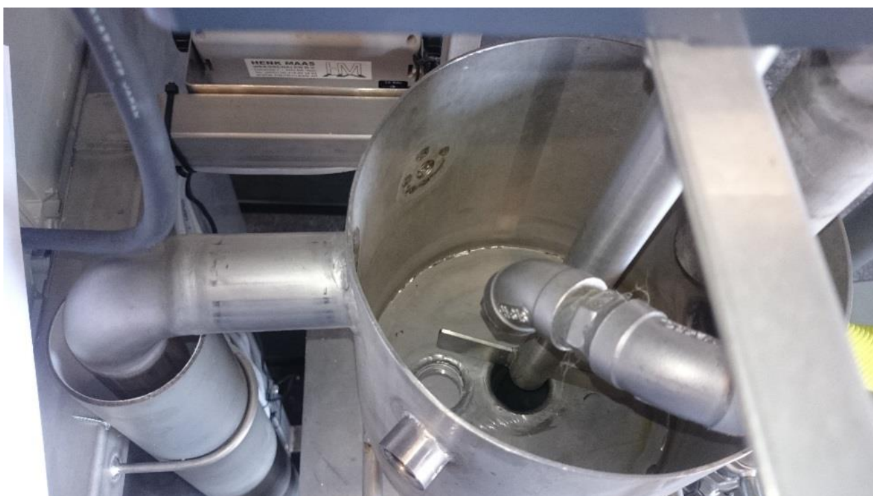
Figur 11: Nærfoto af det lille kammer, hvor omrører, tilløb og rentvand-forsyning ses stikkende ned i beholderen. Til venstre er overløbet samt et gevindstykke til niveaumåleren. I bunden ses afløb samt gevindstykke til at forbinde peristaltpumpen.
