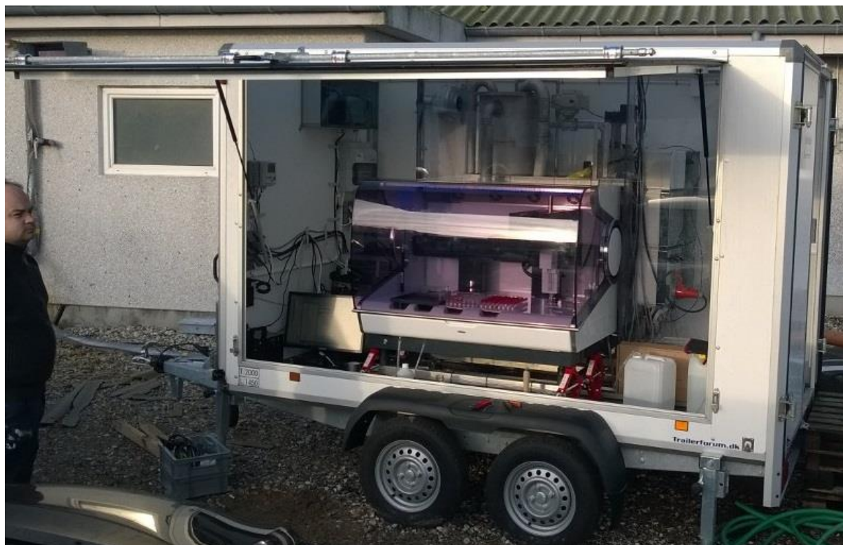
Figur 9: Fotografi af trailer fra betjeningslågen. Forrest står robotten på en stålramme for at beskytte den imod rystelser. I baggrunden ses den øverste del af prøvetageren.
