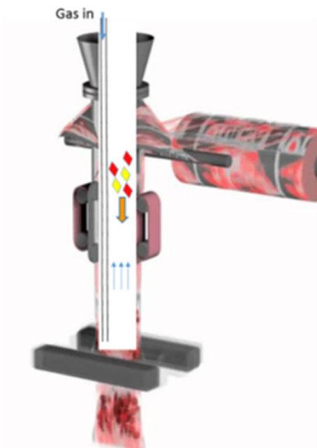
Figur 3: Modsatrettede luftstrømme i fylderøret skader MAP
