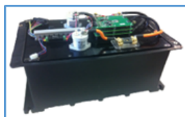
5 kWh lithium-ion batteri med 4 kWh effektivt lager passer godt til et solcelleanlæg på 3–5 kWp
