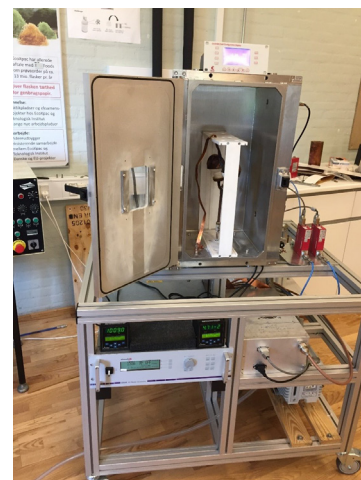
Figur 4: Den nye plasma-coater. Vakuumkammeret er åbent, så man kan se elektrodesystemet til belægningen af to papirflasker. Den hvide plastikramme i kammeret er designet til at kunne holde to A3-ark.
