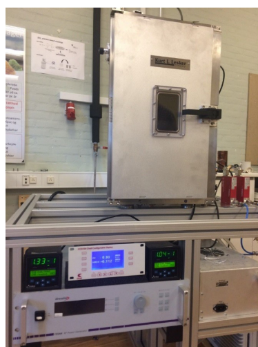
Figur 3: Den opskalerede plasma-coater, som kom i anvendelse i sommeren 2016.
