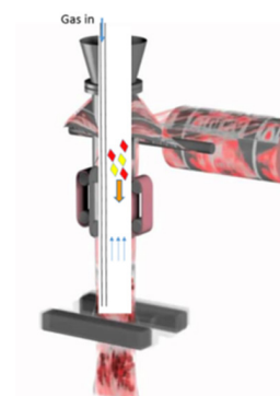
Figur 3: Frit fald gennem pakkerøret kan medføre turbulente strømninger, der fører endnu mere luft ned i pakningen.
