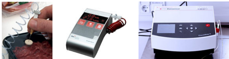
Figur 5: Headspace analysers i dag med en nål
