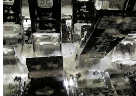
Foto 22. Tromle og lapper efter sæbeudlægning.
