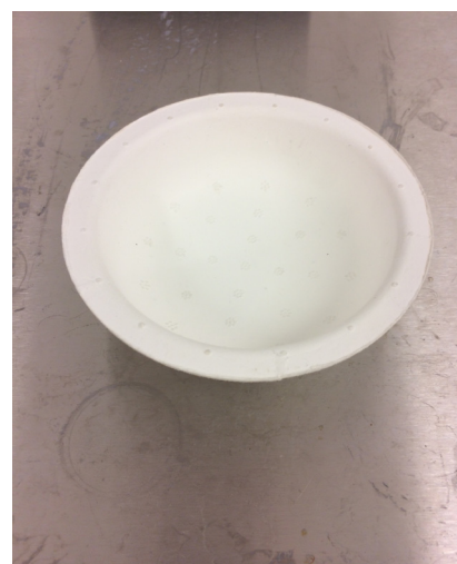
7. Resultatet er et tørt formstøbt emne i papir/pap.
