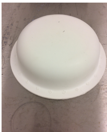
7. Resultatet er et tørt formstøbt emne i papir/pap.
