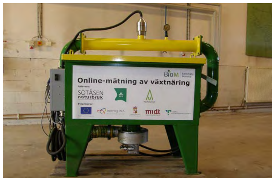
Figur 10.1 Den testrigg som byggts inom aktiviteten och som används för analys av flytande gödsel. Pumpen på undersidan pumpar gödseln i tanken genom röret. På ovensidan av röret sitter mät huvudet med ljuskälla och fiberoptik för registrering av ljus reflekterat av gödseln genom ett safirglas. På vänstersidan sitter själva NIR-instrumentet med detektorn i en IP 65-skyddad låda.
