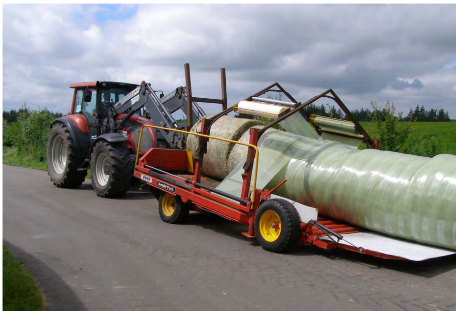
Figur 3.6. Indpakning af ballerne i strækfolie med specialmaskine.
