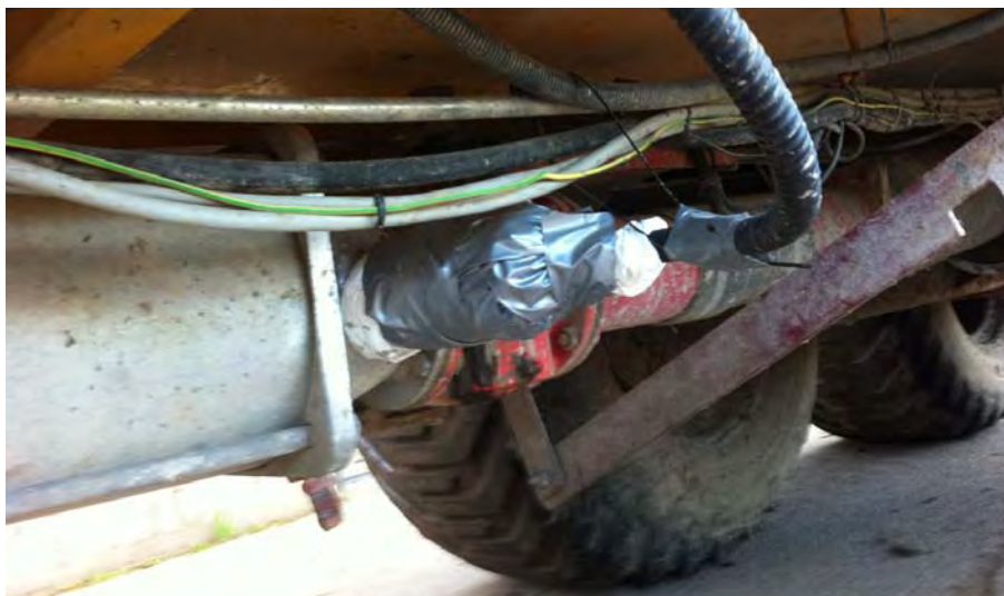
Figur 10.2. NIR-utrustningen placerad på flytgödselspridare. Den provisoriska inkapslingen är till för att skydda mätenheten från smuts och vatten.
