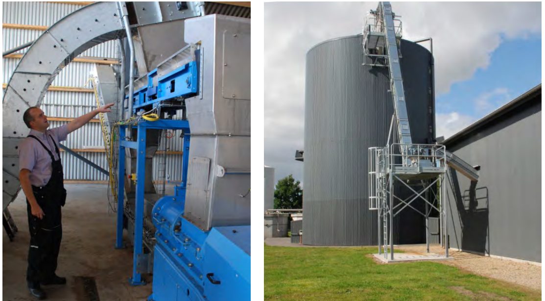
Figur 5.1 Illustration af ekstruder og indfødningsanlæg til fast biomasse
