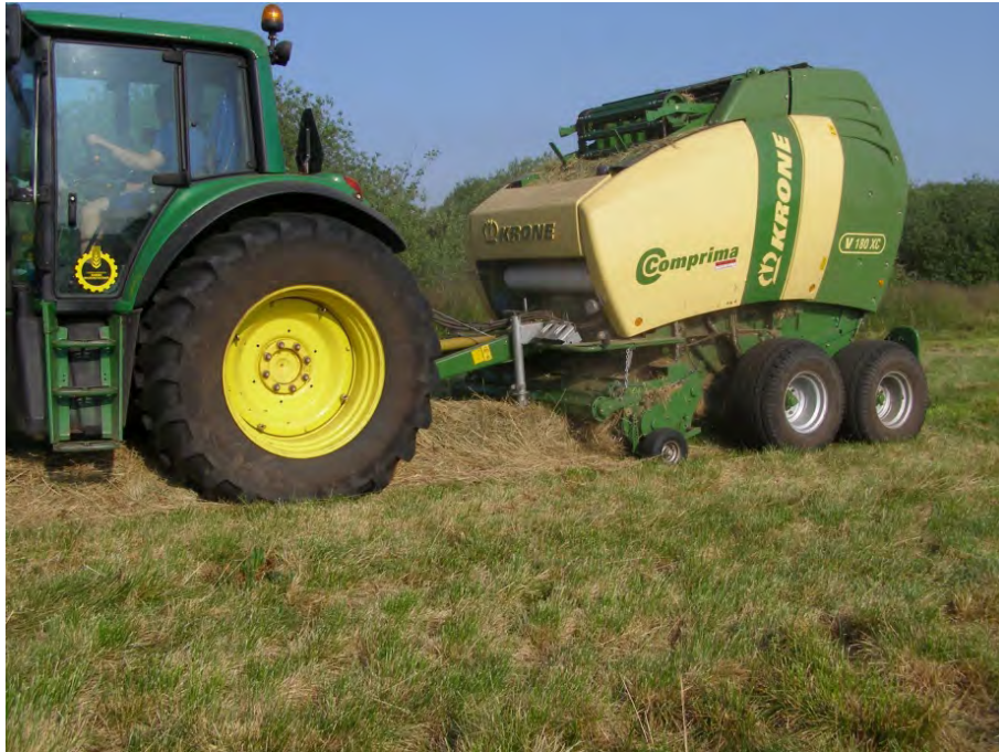
Figur 3.2 2009 og 2010 Græsset blev presset med en rundballepresser med boogieaksel = lav akselbelastning.
