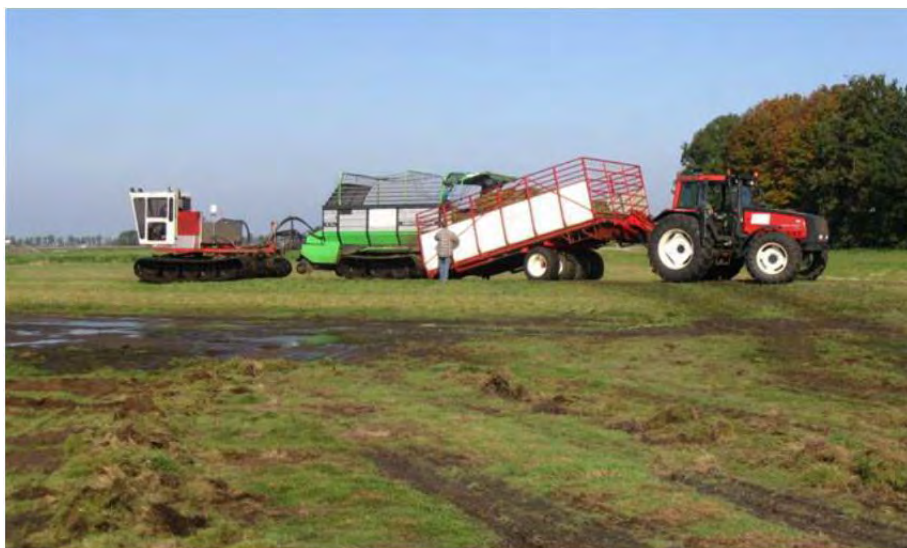
Figur 3.10. Avlastning enligt koncept från holländska De Vries Cornjum där självlastarvagnen dockar till ett traktordrivett mobilt avlastarbord/släpkärra. Foto: De Vries Cornjum.
