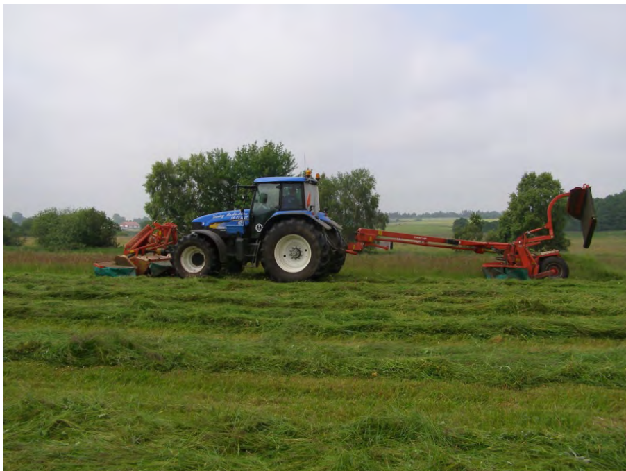
Figur 3.1. Skårlægning med front- og bagmonteret skivehøster 2010.
