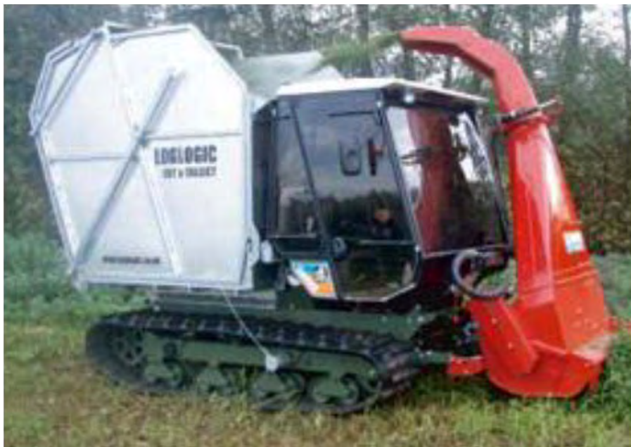
Figur 3.9. Softrak från Loglogic ( http://www.loglogic.co.uk ) i England kan utrustas med en frontmonterad 1,3m bred slaghack som blåser grönmassan till en tippningsbar behållare. Foto: Loglogic.
