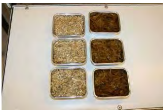
Figur 4.1. a) Halm, før og efter ludning.
