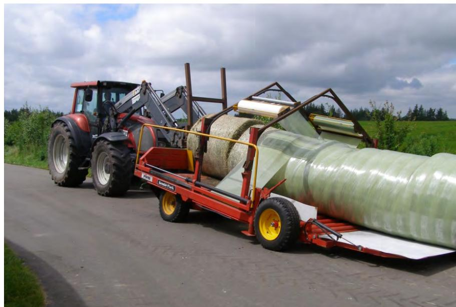
Figur 9.6. Indpakning af ballerne i strækfolie med specialmaskine.
