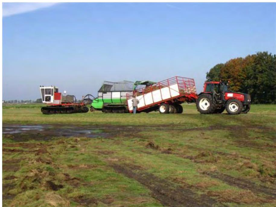
*Figur 9.10. Avlastning enligt koncept från holländska De Vries Cornjum där självlastarvagnen dockar till ett traktordrivet mobilt avlastarbord/släpkärra.*
