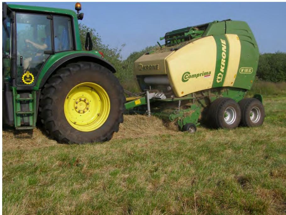
Figur 9.2 2009 og 2010 Græsset blev presset med en rundballepresser med boogieaksel = lav akselbelastning.
