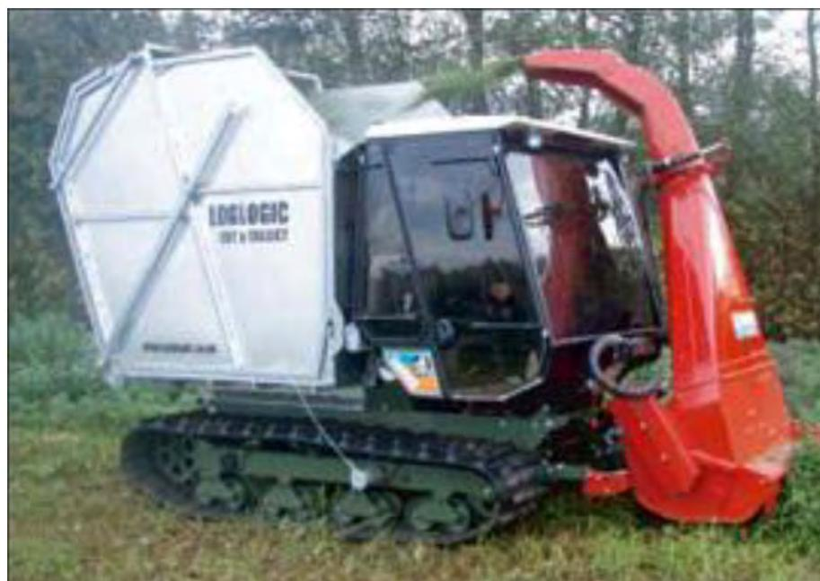
*Figur 9.9. Softrak från Loglogic (<http://www.loglogic.co.uk>) i England kan utrustas med en frontmonterad 1,3m bred slaghack som blåser grönmassan till en tippningsbar behållare. Foto: Loglogic.*
