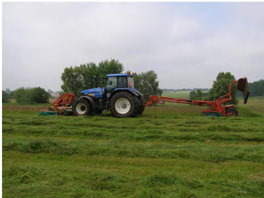
Figur 9.1. Skårlægning med front- og bagmonteret skivehøster 2010.
