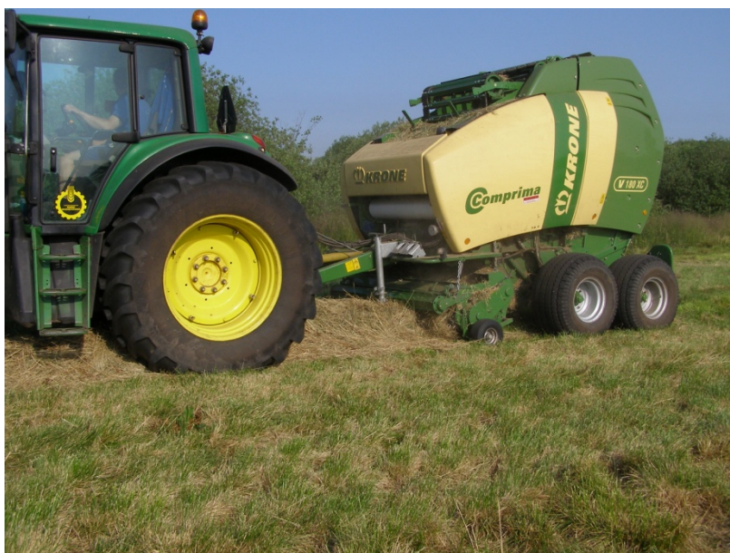
Billede 4. Græsset blev presset med en rundballepresser med lav akselbelastning.
