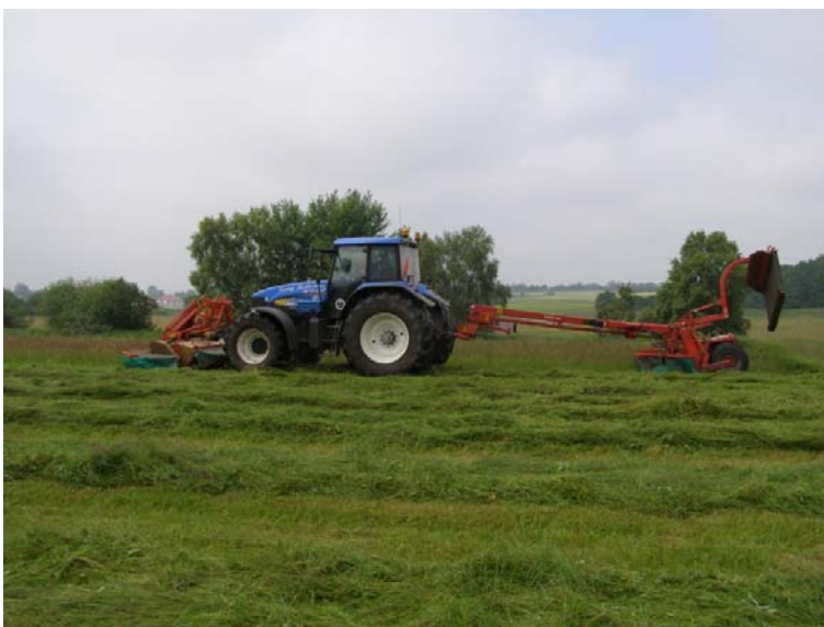
Billede 2. Skårlægning med front- og bagmonteret skivehøster.
