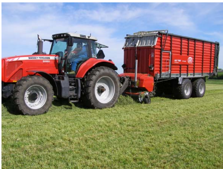
Billede 9. Opsamling af græs med selvlæssende snittevogn.
