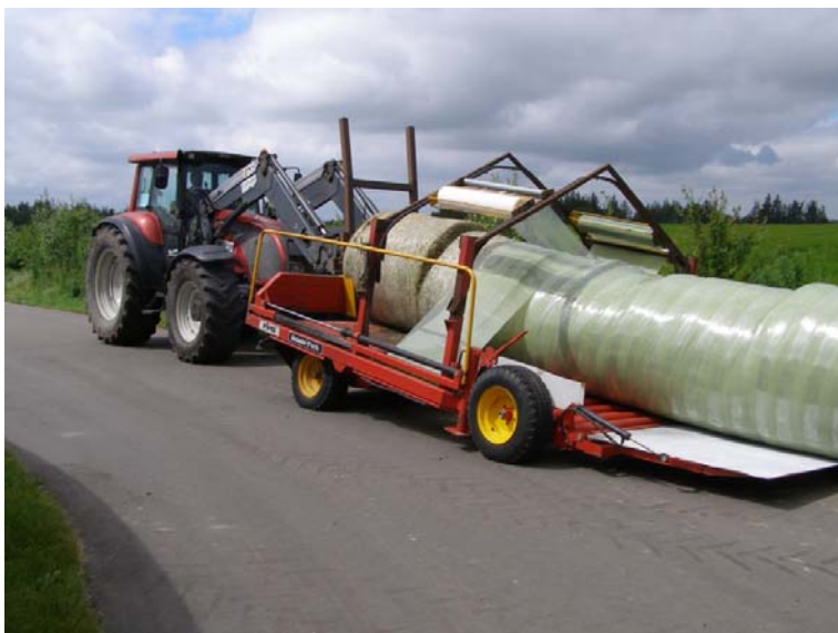
Billede 7. Indpakning af ballerne i strækfolie med specialmaskine.
