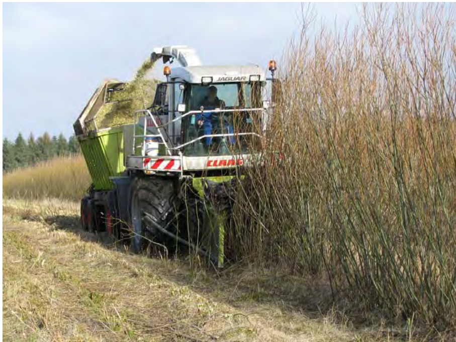
Foto 6.1. Finsnitter der høster og fliser pil i samme arbejdsgang.
