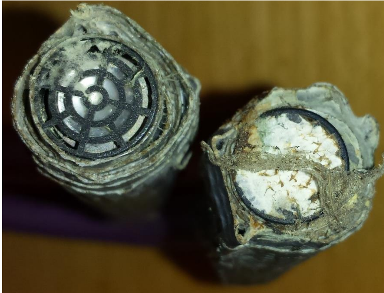
Billede 26 – Viser hvordan ultralydssensorerne er blevet tilsnavset efter få uger.
