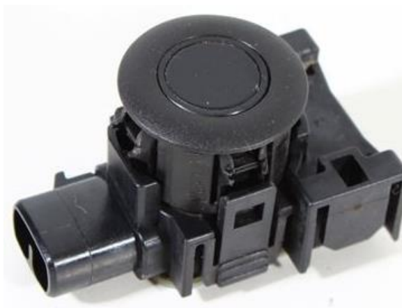
Billede 14 – Til venstre ses en løs ultralydssensor og til højre en ultralydssensor monteret på en personbil.
