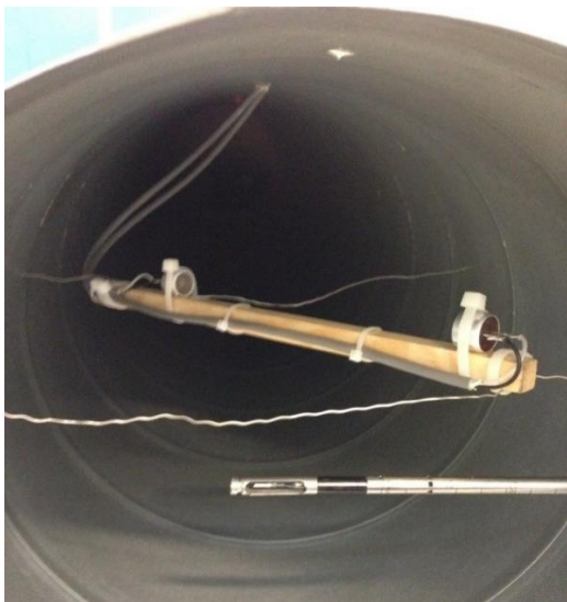
Billede 18 – Ultralydssensor placeret i ventilationskanal, hvor målingerne sammenlignes med måling fra en TSI.
