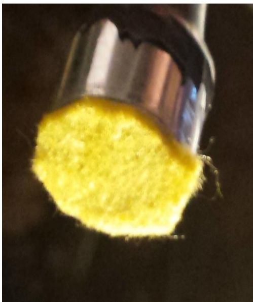
Billede 27 – Ultralydssensor med påmonteret filter.
