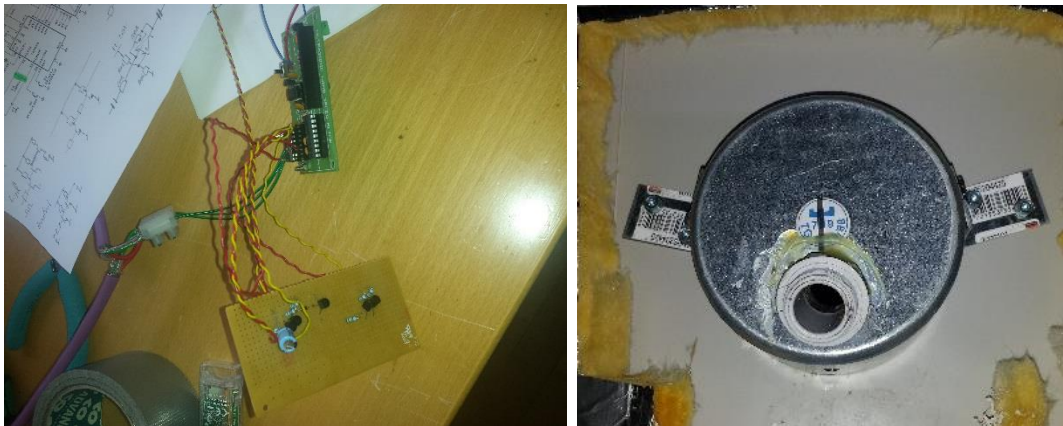
Billede 28 – Til venstre ses forstærkningsmodulet som eftermontere i el-boksen og til højre lommen, hvori ultralydssensorerne monteres i.
