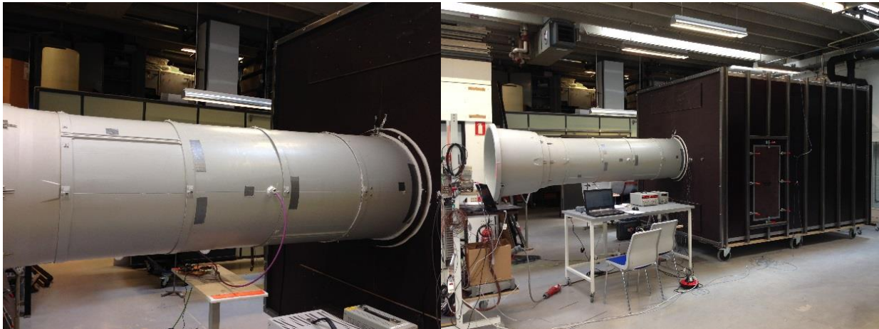
Billede 23 – Måleopstilling med ultralyd, hvor signal outputtet fra ultralydssensorerne logges.
