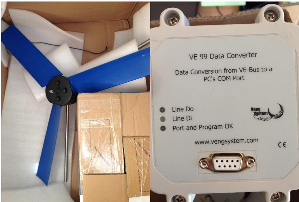
Billede 7 – Målevinge med dertilhørende data konverter fra VengSystem.
