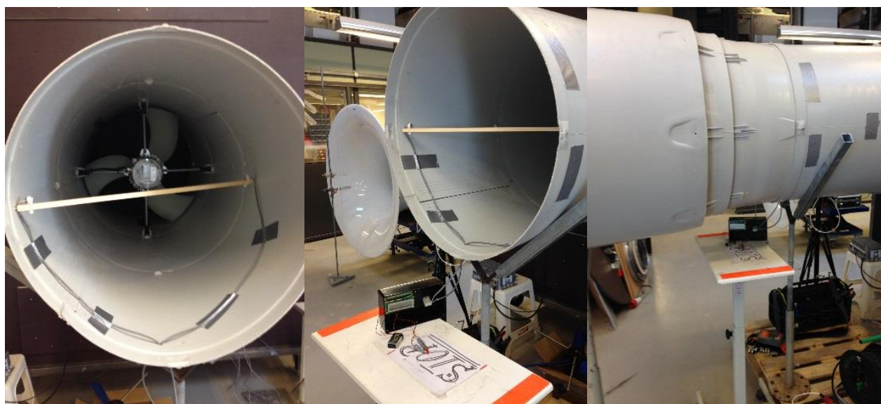
Billede 20 – Måleopstilling, hvor ultralydssensorerne er indsat i Skovs afksthætte.
