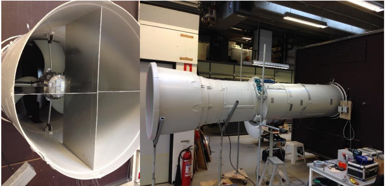
Billede 22 – Måleopstilling med linearisator kryds som placeres i indløbsstragten og ikke som vist på billedet.
