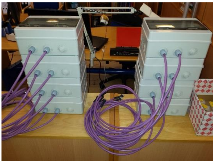
Billede 24 – Elektronikboks med ultralydssensorerne monteret og datalogger.
