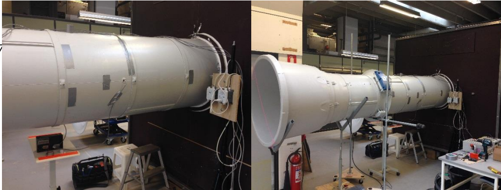
Billede 1 Ultralyd sider på sugesiden af skov ventilator.
