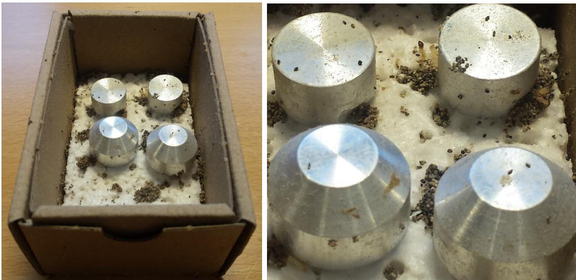
Billede 30 – Indkapslede ultralydssensorer efter robusthedstest i den fælles luftskakt før luftrensningsanlægget.
