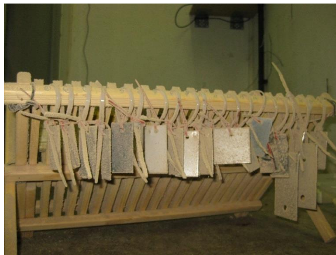
Figur 4: Test rack med korrosion sonder efter 700 timer eksponering.
