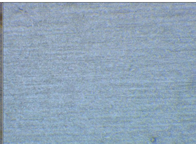
Figur 20: Overflade efter eksponering på rustfrit stål (kupon 19) efter rengøring ved 25X forstørrelse.
