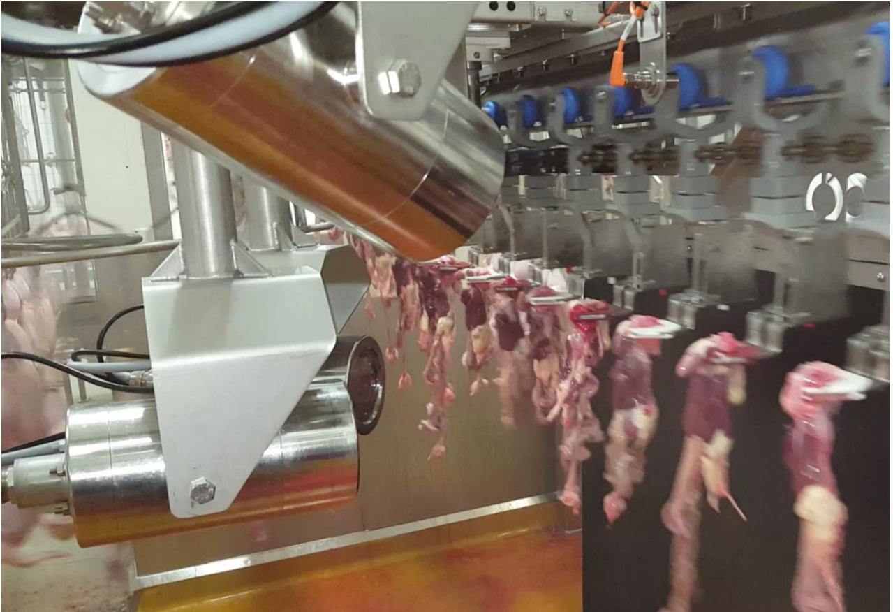
Figur 1: Opstilling anvendt til billedoptagelse bestående af IHFood Vision tuber med farvekamera og lys monteret på den ene side af linjen. En sort baggrund er placeret på den anden side. Efterfølgende er der også blevet opsat afskærmning bag tuberne for at skærme for lysener.
