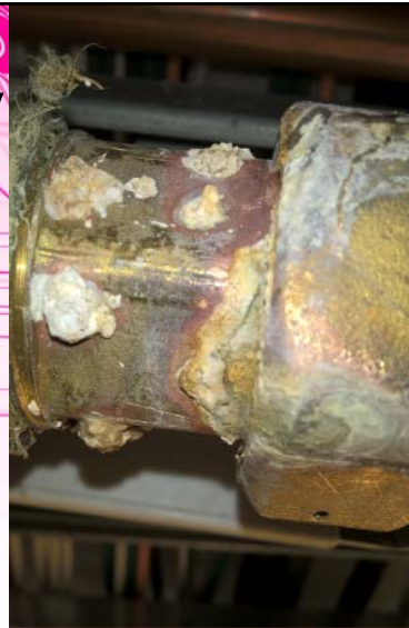
Tecknen på avzinkning är vita zinkoxidpulver avsättning och rött färg
