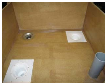
Alla tätskikt har monterats av respektive tillverkare
