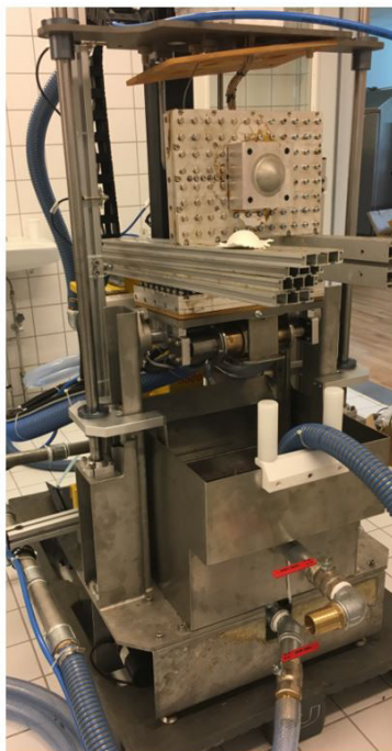
Billede 1: Mini-papirfabrik, forme til fremstilling af emballager og eksempler på færdige emballager
