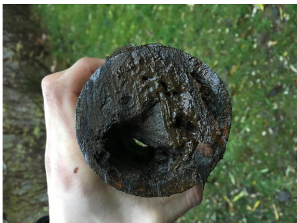
Figur 7.4. I køkkenfaldstammer er der ofte mange aflejringer
