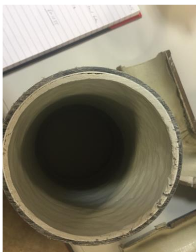
Figur 6.12. Eksempler på coating med godstykkelse \geq 1 mm
