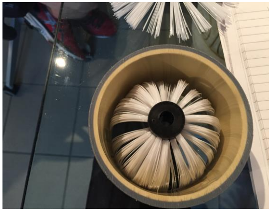
Figur 2.5. Børste til fordeling af coating
