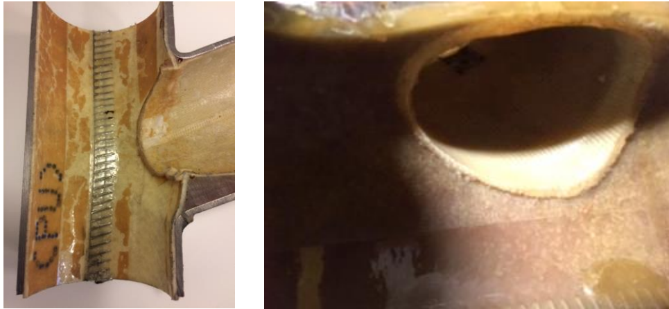
Figur 6.10. Tilslutning af sidegren til faldstamme med kantlimning
