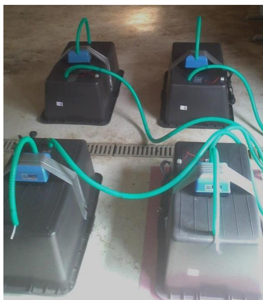
Figur 2. Foto visende de fire fluxkamre med løbende luftudskiftning (grønne slanger) samt luftpumpe (blå).
