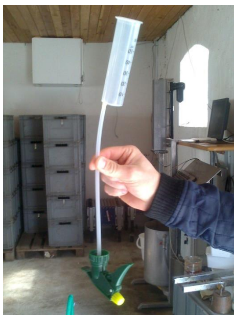
Figur 1. Vandforstøver påmonteret væskebeholder med volumenindikator.
