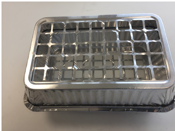
Figur 1: Emballageenhed designet til at opnå en jævn varmefordeling. Denne fungerer som en reflektor, som derved kan styre hvor meget energi, der skal lukkes ind til produkterne, og hvor denne energi skal fokuseres.
