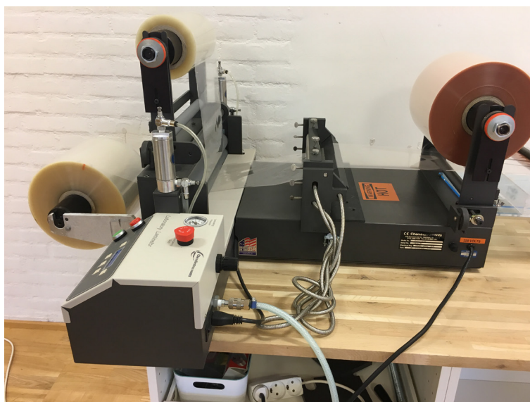
Foto 1: Teknologisk Institut har pilot laminator, der kan fremstille de ønskede genanvendelige emballagefilm.
