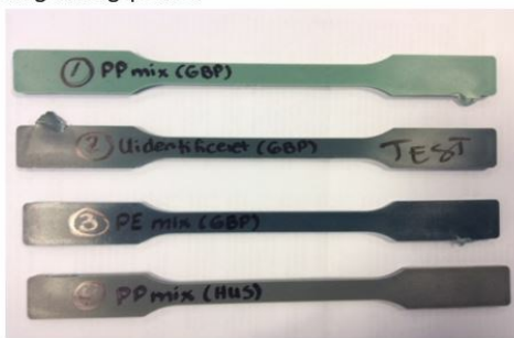
Prøvestænger produceret af polymersorteret sort plast
