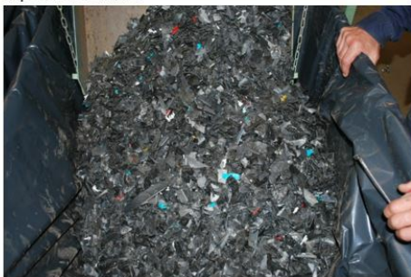
Neddelte flakes tilført det tyske sorteringsudstyr
