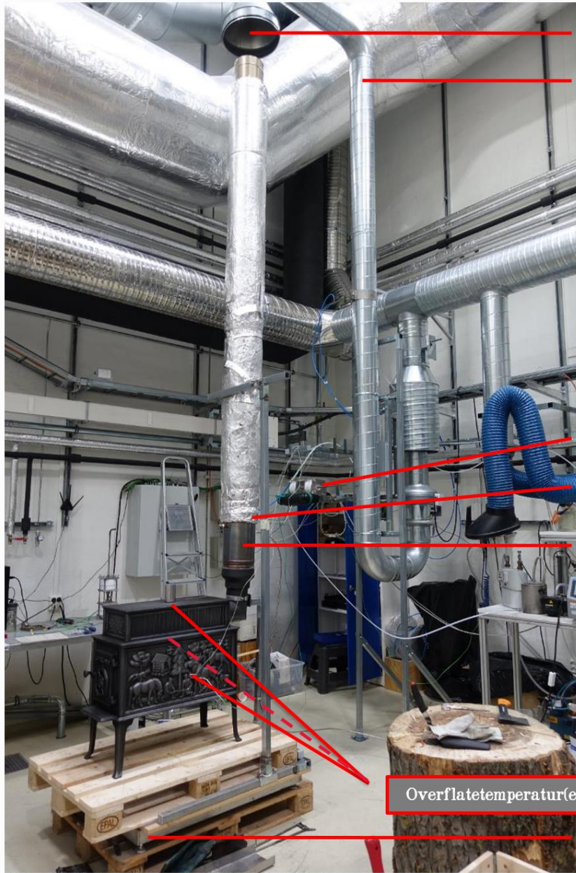
Figur 5. Typisk måleoppsett iht. NS 3058/59
