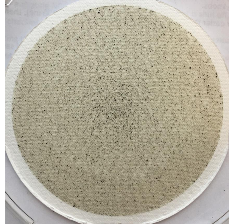
Prøveudtagning på quartz filter fra 1 charge ((ca. 1.75 kg brænde og fortyndinggrad på 33) - ESP ON
