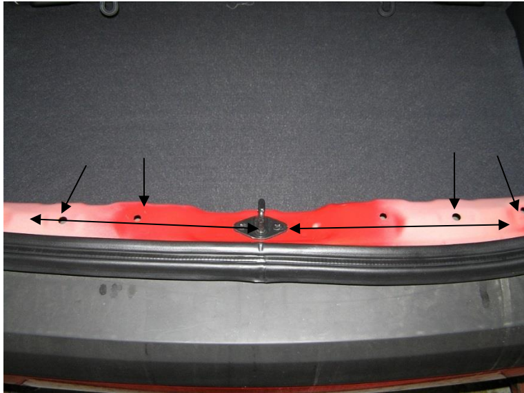
Behandling af hulrum i bagpanel i bagagerum.
