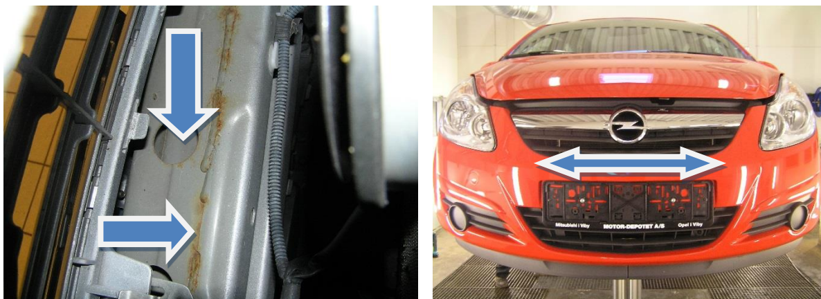
Behandling af overflader og hulrum i tværvange foran køler.
