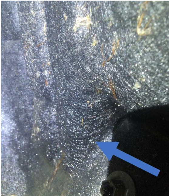
Fugtig filtinderskærm i hjulkasse.
