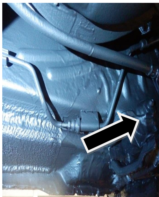
Traverser og forstærkninger bag forhjul og foran baghjul og bundplade.
