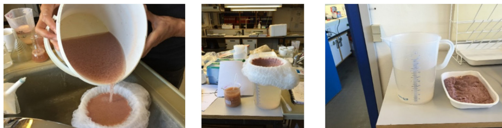
Fra venstre mod højre: Rejespildevand tilsat flokkulanter; før og efter flokkulering; separeret vand og flokkuleret materiale.
