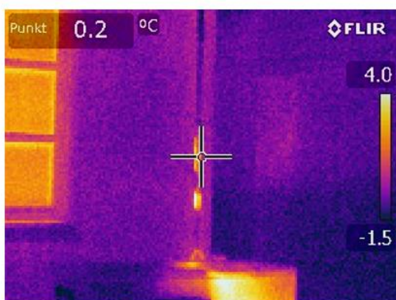
Figur 4.6 Eksempel på mangelfuld isolering af rør fra varmepumpen og ind til indemodulet. Øverst med dårlig isolering og nederst med korrekt udført isolering.
