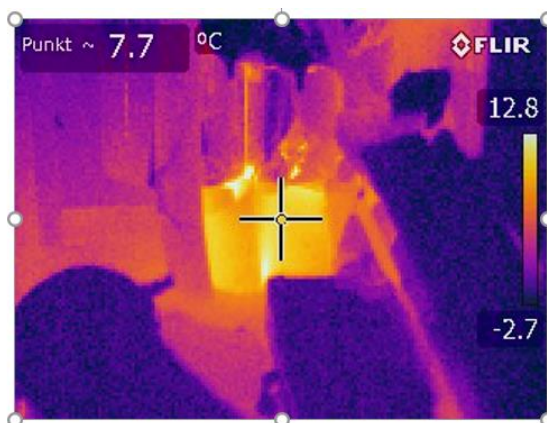
Figur 3.6 Luft/Vand-varmepumpeanlæg. Der er anvendt ubrugeligt isoleringsmateriale.
