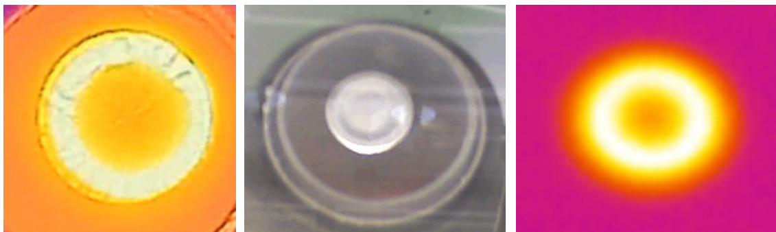
Figur 4, IR-billede, Induktionssvejsning af metalfolie, periferien bliver opvarmet og smelter fast. Se film af induktionssvejsning set med IR-kamera på hjemmesiden, der henvises til sidst i artiklen.
