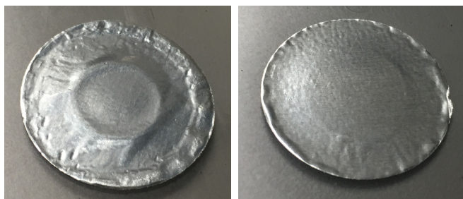
Figur 2, Metalfolier hvor man kan se at periferien er smeltet fast, mens midten ikke er blevet så varm.
