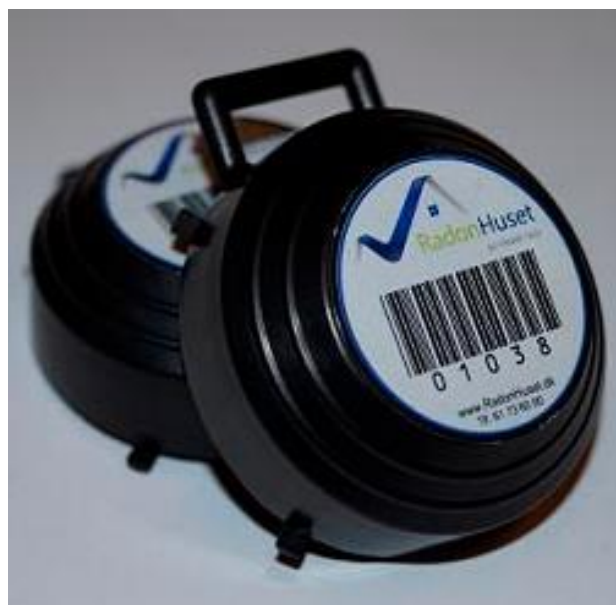
Dosimeter med sporfilm anvendt til måling af radon i fyringssæsonen
