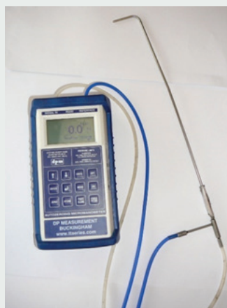
Figur 2 – Manometer med tilhørende pitotrør
