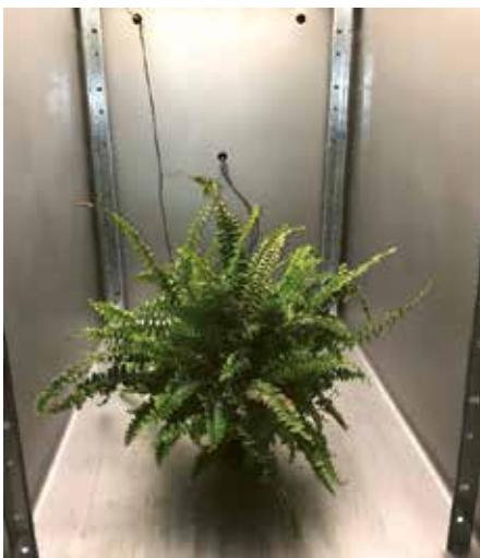
Figur 2: Nyrebregne, Nephrolepis , placeret i plantemålekammer. Daglængden var på 12 timer suppleret med hvide LED dioder i toppen af kammeret. CO 2 koncentration, temperatur, relativ fugtighed og lysintensitet blev målt kontinuerligt i løbet af forsøget. Sensorerne ses bag planten på billede 2.
