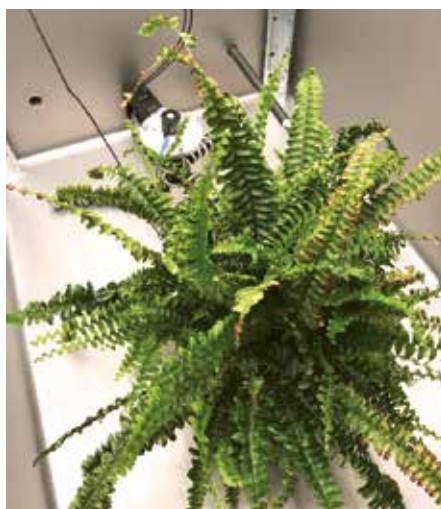
Figur 2: Nyrebregne, Nephrolepis , placeret i plantemålekammer. Daglængden var på 12 timer suppleret med hvide LED dioder i toppen af kammeret. CO 2 koncentration, temperatur, relativ fugtighed og lysintensitet blev målt kontinuerligt i løbet af forsøget. Sensorerne ses bag planten på billede 2.
