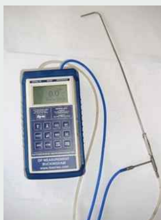
Figur 2 – Manometer med tilhørende pitotrør
