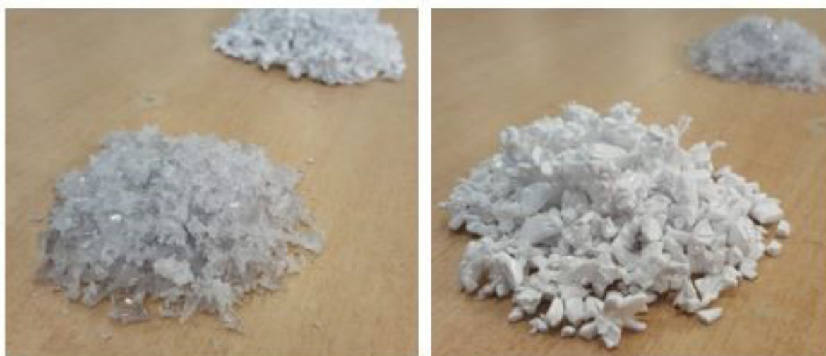
Billederne viser granulat af blød PVC fra medicinsk engangsudstyr hhv. før og efter behandling med superkritisk CO 2 . Granulatet går fra let blålige og klare (til venstre) til mælkehvide i farven (til højre). Hvad der ikke er så tydeligt på billederne er, at granulatet også bliver hårdt og sprødt. Alt sammen tegn på udvaskning af blødgørere og additiver. Kilde Mark Holm Olsen, Plast og Emballage, Teknologisk Institut.
