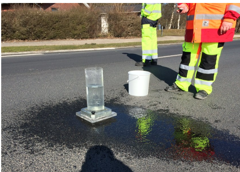
Figur 7.2-2: Bestemmelse af permeabilitet efter Becker-metoden. Pleksiglasrøret monteres med tætsluttede gummiring/kit mod asfaltoverfladen. Der fyldes vand i til glassets øverste markeringsring, hvorefter der med stopur foretages bestemmelse af udløbstiden, indtil vandsøjlen passerer den nederste markeringsring på røret. Udløbstiden bestemmes i sekunder pr. 10 cm vandsøjle.
