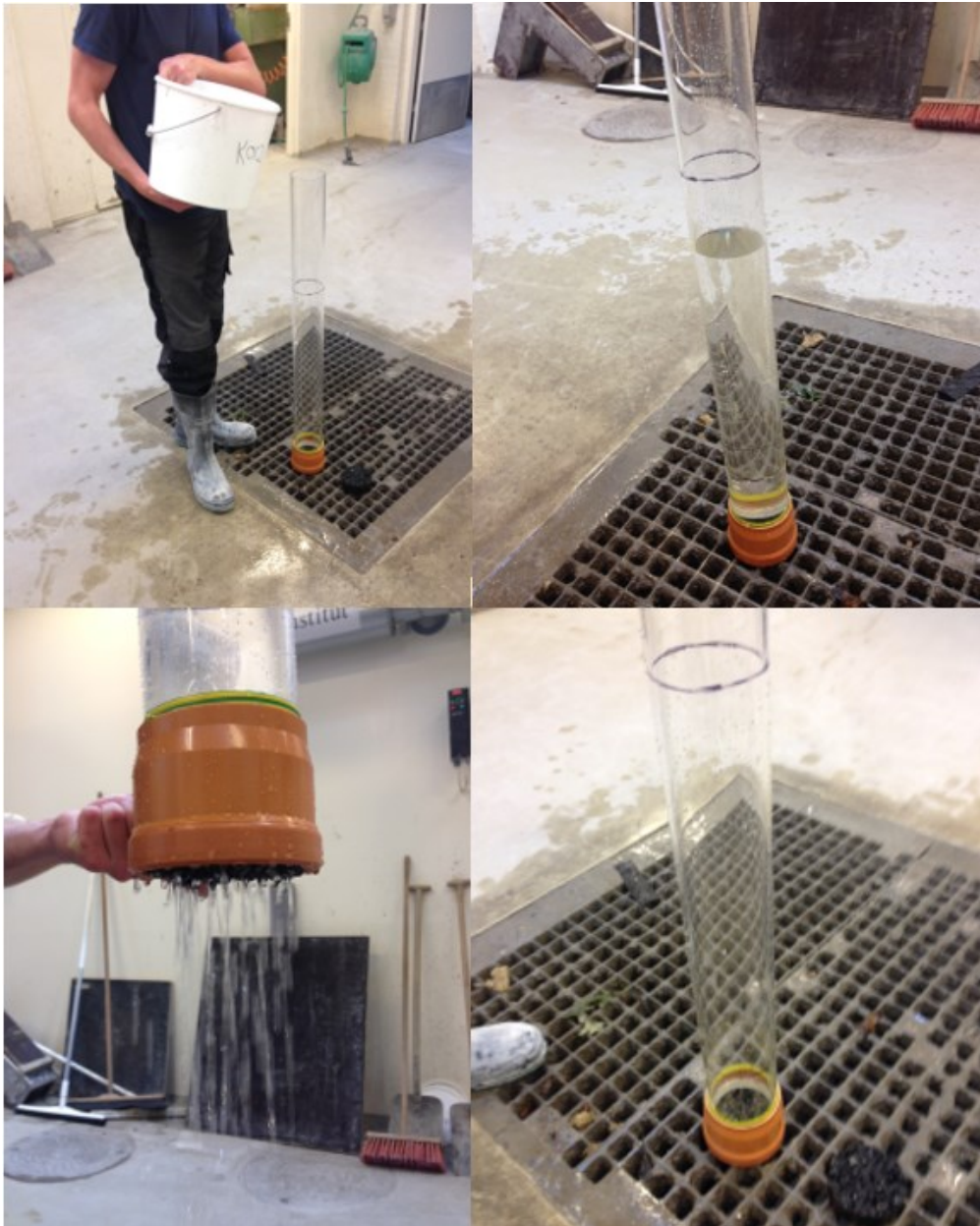
Figur 9.2-3: Måling af gennemløbstid:
