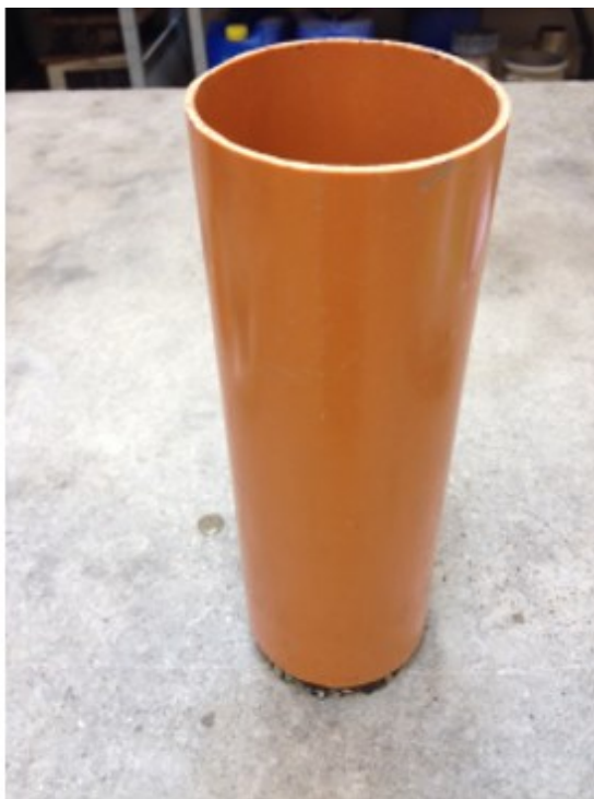
Figur 9.2-4: Tilslemning. Blandingen ovenfor. Kerne (t.h.) monteret i et Ø100 mm plastrør (indre diameter), der slutter tæt om kernen.
