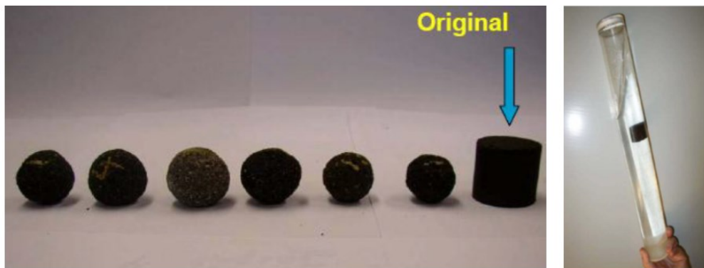
Figur 5.2-3: Våndskak-test for bedømmelse af forskellige filleres vedhæftningsevne. Testudfald t.v. og testrør t.h.
