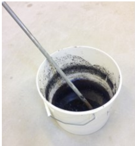
Figur 9.2-4: Tilslemning. Blandingen ovenfor. Kerne (t.h.) monteret i et Ø100 mm plastrør (indre diameter), der slutter tæt om kernen.
