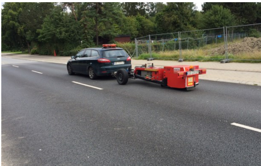
Figur 7.3-4: Rullemodstanden på Klimavejsbelægningen på Korsdalsvej blev bedømt med specialudviklet måletrailer fra det tekniske universitet i Gdansk, Polen (TUG)
