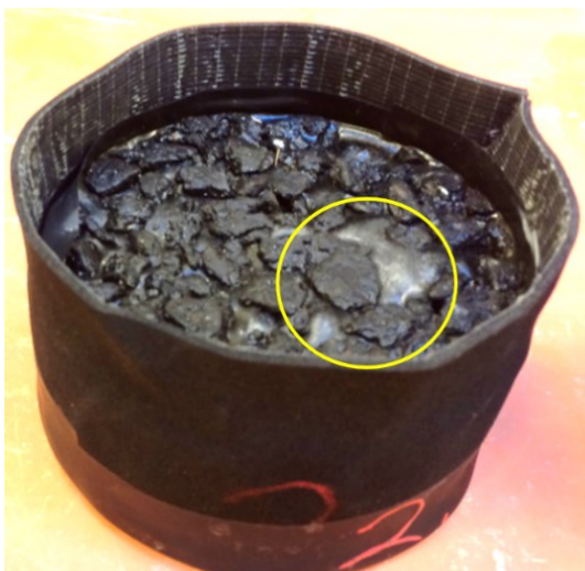
Figur 10.9-2: Ved 80 % vandfyldningsgrad ses tydelige islinser i overfladen – dog stikker de ikke op over stentoppene, så tilstrækkelig friktion i belægningstoppen vurderes fortsat at være til stede.
