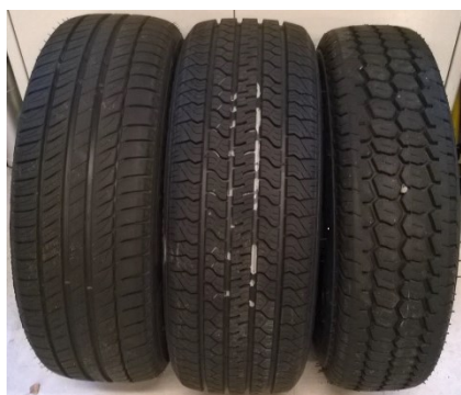
Figur 7.3-6: Ved rullemodstandsmåling anvendes tre forskellige dæk. Et personbilsdæk med f. hv. lav rullemodstand (Michelin Primacy), et referencedæk (SRTT) og et grovmønstret dæk (Avon AAV4), som simulerer (mindre) lastbiler. [L7.3.-4]
