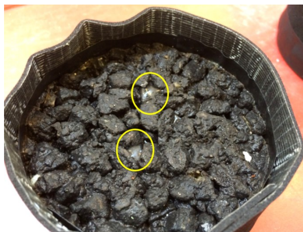
Figur 10.9-1: Begyndende synlige islinsedannelser ved 75 % vandfyldning af hulrum. Linserne stikker ikke op over stentoppene.
