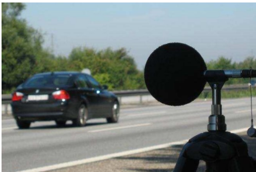
Figur 7.1-0: Princip ved Statistical Pass-By støjmåling, hvor et antal forbigående bilers støjafgivelse opfanges af en mikrofon i en fast defineret placering i vejens yderside. SPB-metoden giver således et billede af den samlede trafikstøj – både motorstøj og dæk/vejstøj
