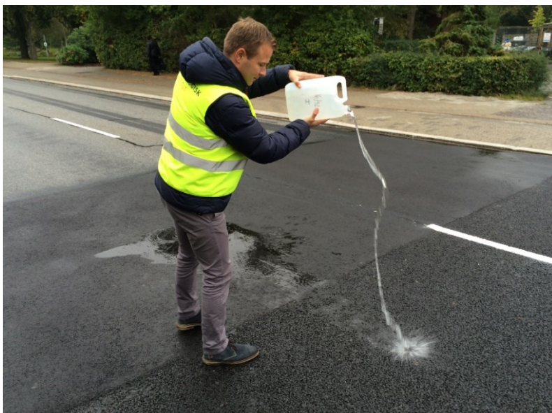
Figur 7.2-1: Simpelt men illustrativt forsøg. Når vanddunken bevæges fra den traditionelle tætgraderede asfaltbelægning på rampen (t.v.) ind over drænasfaltbelægningen (t.h.) "forsvinder" vandet ned i drænasfalten.
