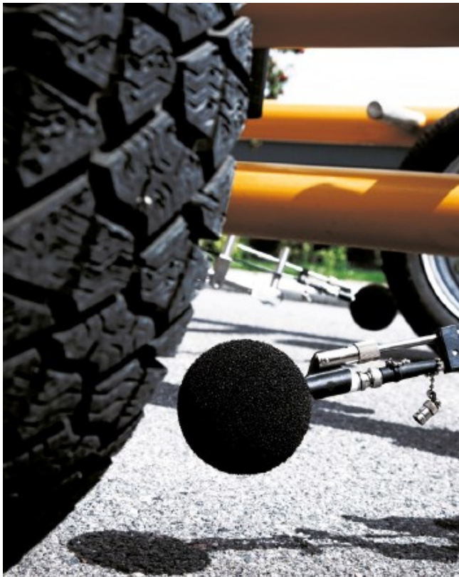
Figur 7.1-2: Nærbillede af mikrofonplacering på anvendte "DeciBella" støjmåletrailer efter CPX-metoden.
