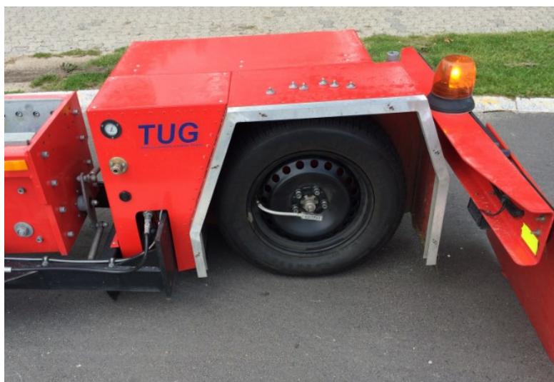
Figur 7.3-5: Til rullemodstandsmåling benyttes den trehjulede trailer fra TUG. Rullemodstanden måles ved det bageste hjul (afskærmet - Billedet viser målehjul ved afmonteret afskærmning). Det sikres løbende at dæktrykket er korrekt.
