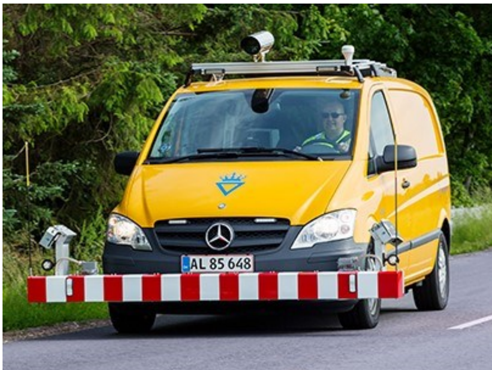
Figur 7.5-2. Vejdirektoratets Profilograf måler samtidigt jævnhed, sporkøring, tekstur og tværfald.
