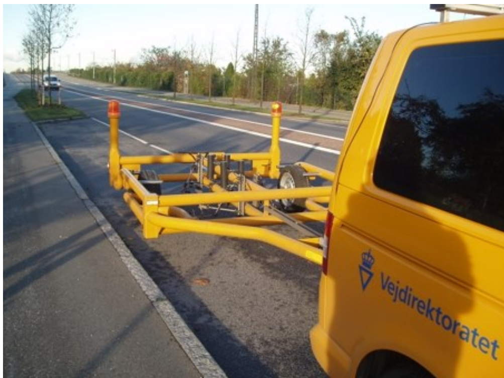
Figur 7.1-1: Vejdirektoratets CPX støjmåletrailer "DeciBella" med mikrofoner placeret tæt op ad dækkene.
