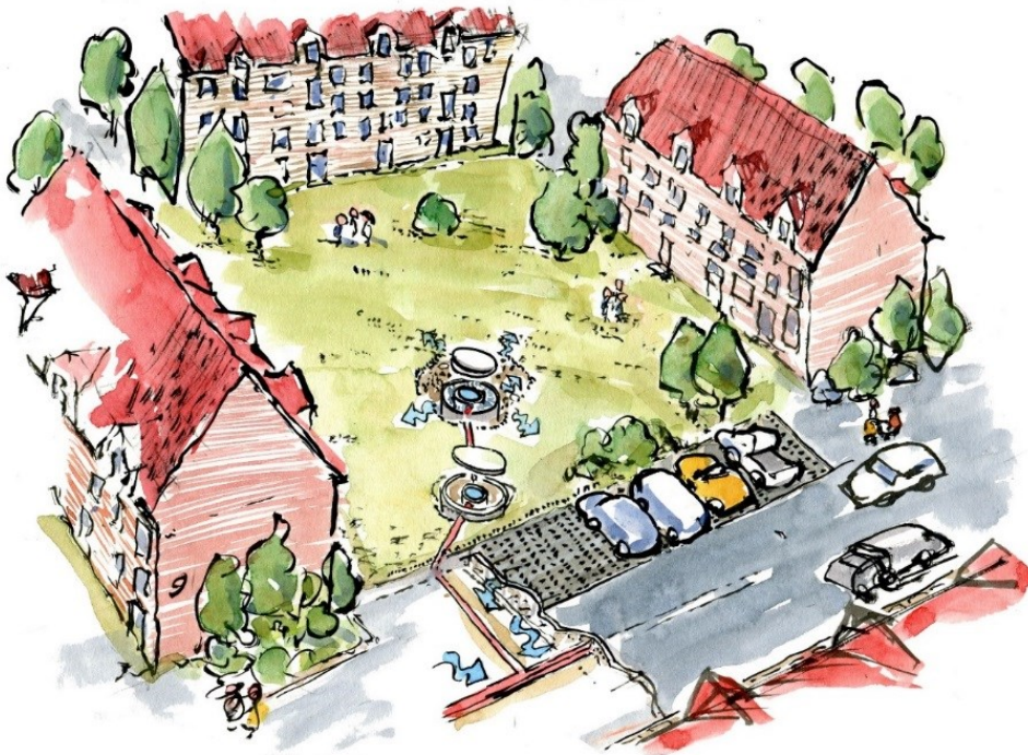
Figur 8.4-2: Princip fra projektet "AkvaVejen". Efter rensning af vejvandet i en serie lokale, sekventielt forbundne rensbrønde, kan det rensede vand f.eks. anvendes til rekreative formål som springvand etc. samt tillades nedsivet i grønne områder, hvor nedsivningen hjælper til at modvirke fordampningen i sommermånederne. Ved den i praksis udførte løsning blev det valgt at indbygge endnu et drængrus vandmagasin under den vandtætte bundmembran, således at det rensede vejvand kunne nedsives på stedet, direkte under vejen.
