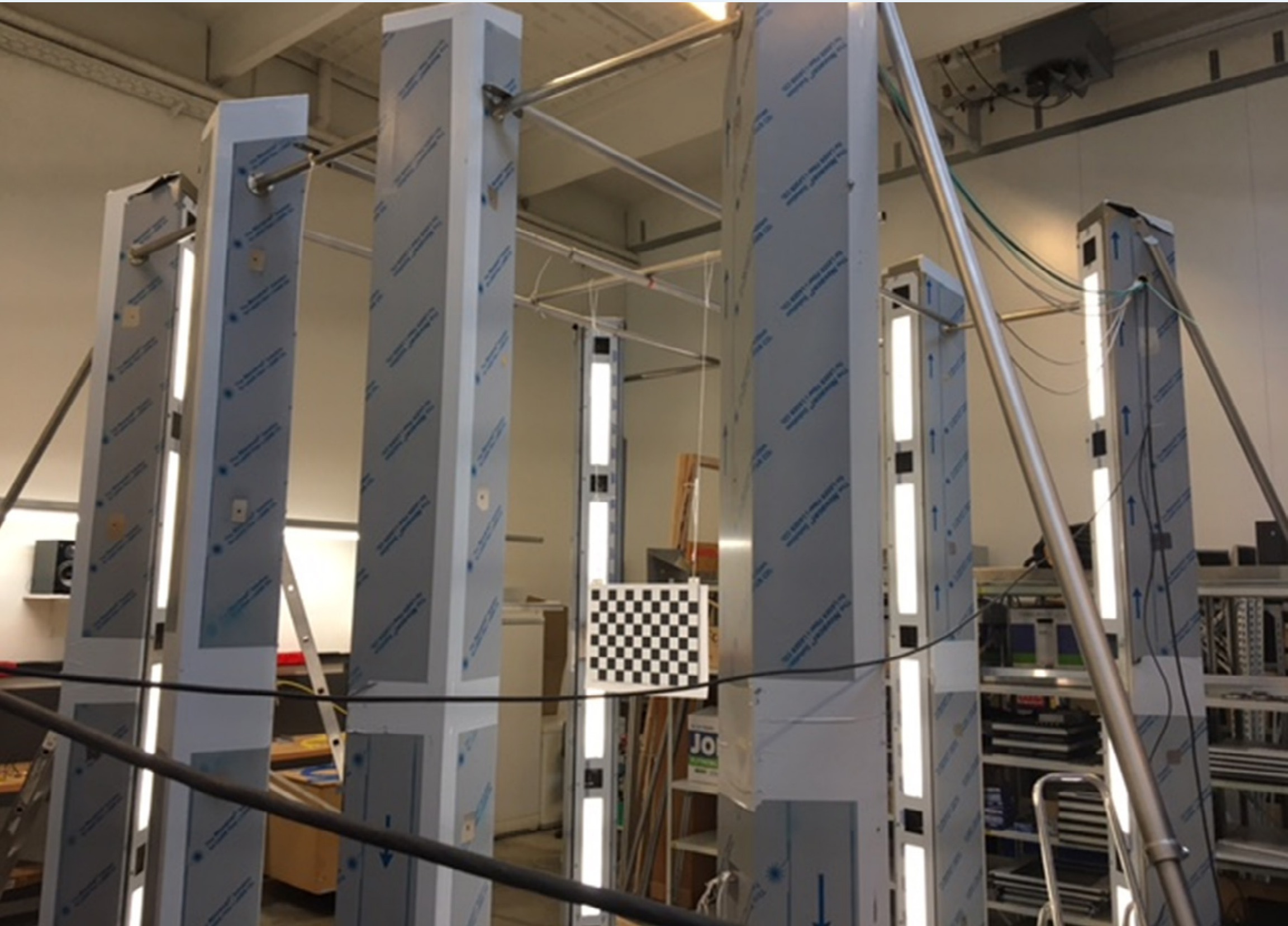
Figur 1. System af kamera-tårne udviklet af Frontmatec (til fotografering af kreatur-kroppe). Vi har købt nogle mindre tårne af dem, som er velegnede til svinekroppe.
