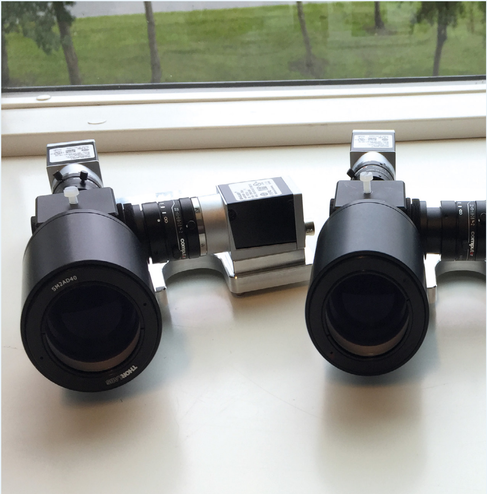
Figur 2. Hjemmesamlede multispektrale kameraer. Samlet af kommercielt tilgængeligt optik og optomekanik, samt almindelige industrielle kameraer. Har høj opløsning (5 MPixel) og fremragende følsomhed.
