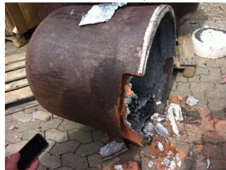
Ødelagt smeltedigel, materialet er grafitholdigt.
