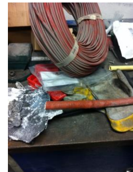
Til kabelføring, er modstandsdygtig overfor smeltet aluminium.
