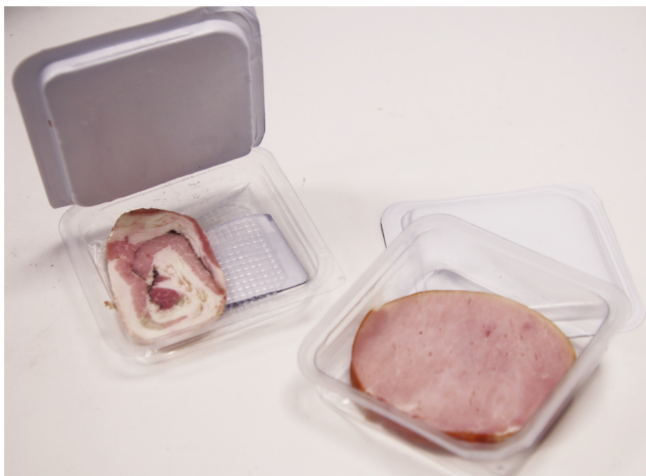
Billede 1: Pålægsemballage af plast, hvor ét lag plast er egnet til fødevarekontakt, mens et andet, kraftigere lag plast sørger for holdbarheden af pakken
