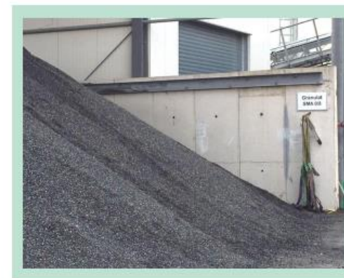
FIGUR 10.2.1: Eksempel på opbevaring af genbrugsasfaltgranulat fra en større SMA-fræseopgave under tag i en tørrehal med åbne gavle. (Foto: TI)
