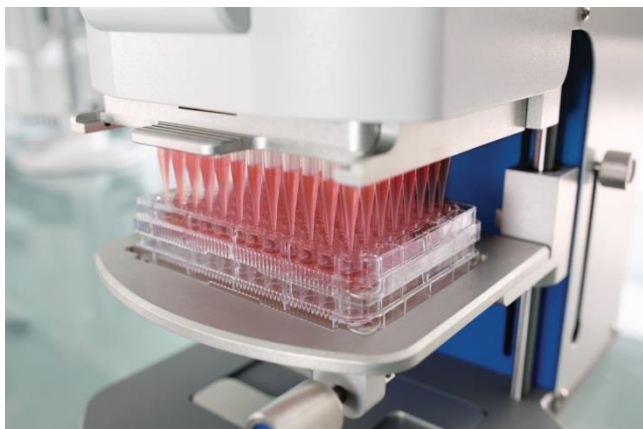
Figur 12. Et eksempel på et multihoved pipetteværktøj til 96 brønds SBS-plader (Tecan)
